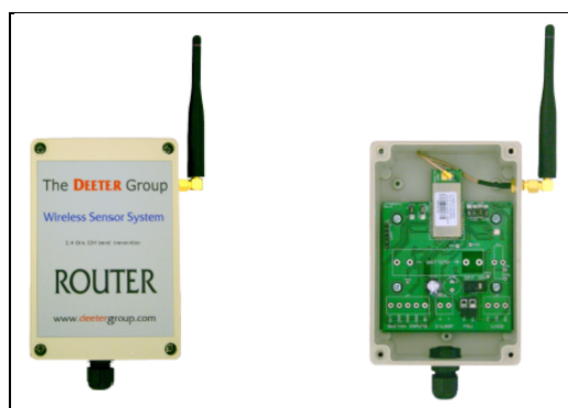
รูปที่ ก.4 อุปกรณ์ที่ทำหน้าที่เป็นสถานีถ่ายทอดที่ใช้อ้างอิงในงานวิจัย
