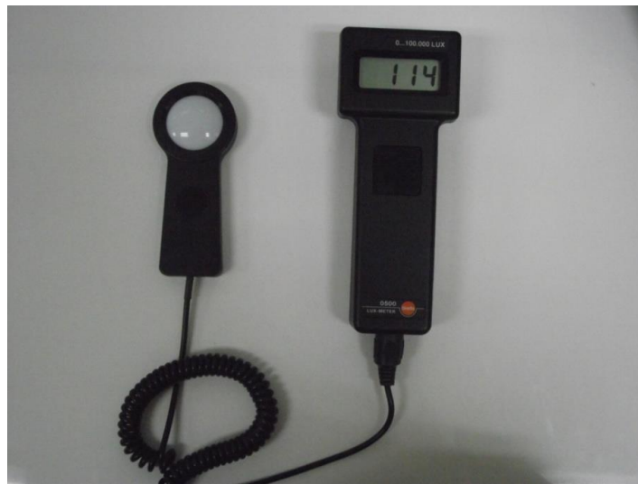
รูปที่ 3.4 เครื่องวัดความส่องสว่างของแสงแบบดิจิตอล
