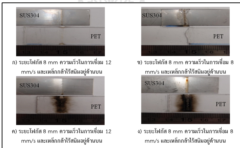
รูปที่ 4.8 ตัวอย่างลักษณะรอยแตกหักของชิ้นงานเชื่อมหลังการทดสอบแรงดึงเนื่อง
