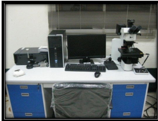
รูปที่ 3.8 กล้องจุลทรรศน์ ยี่ห้อ Olympus High Power Microscope รุ่น BX 51 พร้อมอุปกรณ์ถ่ายภาพและเครื่องคอมพิวเตอร์
