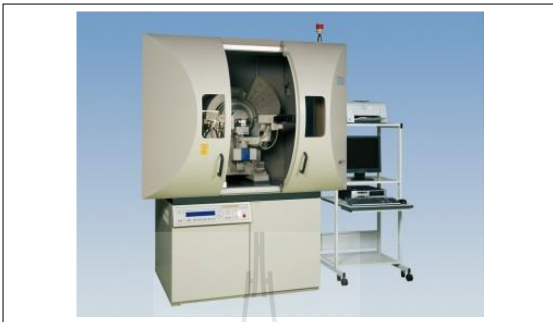
รูปที่ 3.5 ภาพเครื่อง X-ray diffractometer (XRD) ที่ใช้ในการวิเคราะห์ฟิล์มบางนาโนซิงค์ออกไซด์
