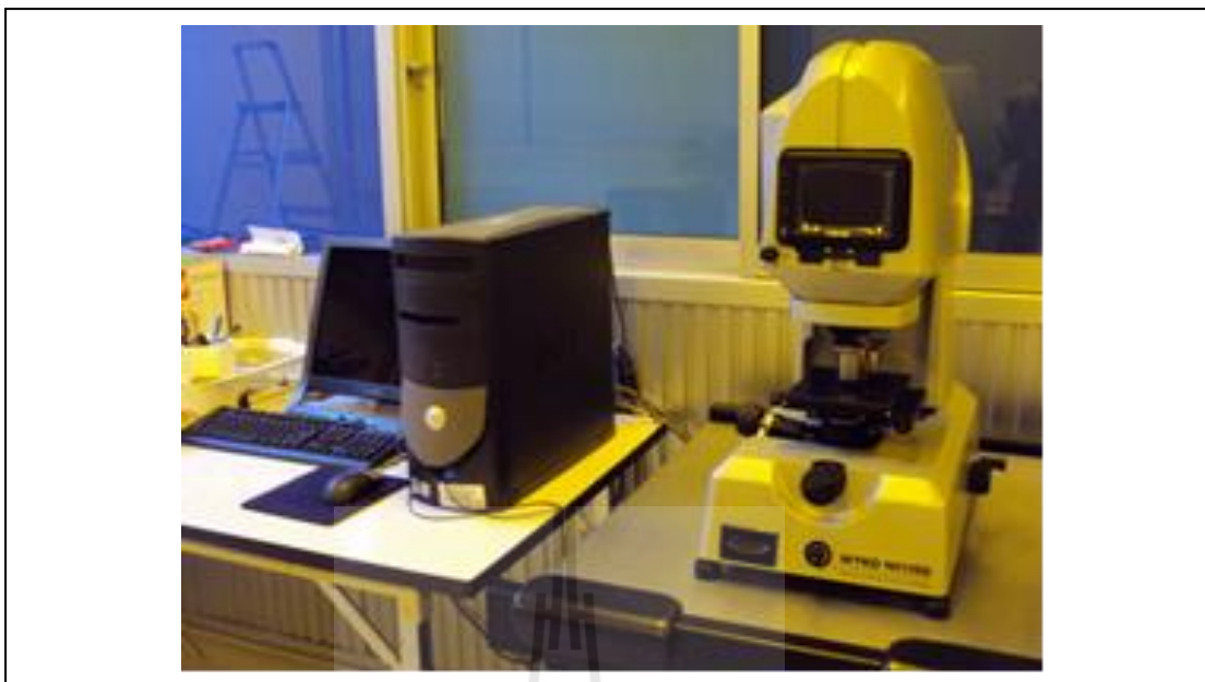
รูปที่ 3.7 ภาพกล้องจุลทรรศน์ออปติคอลโพลาไรซ์ที่ใช้ในการวัดความหนาของฟิล์มบางนาโนซิงค์ออกไซด์
