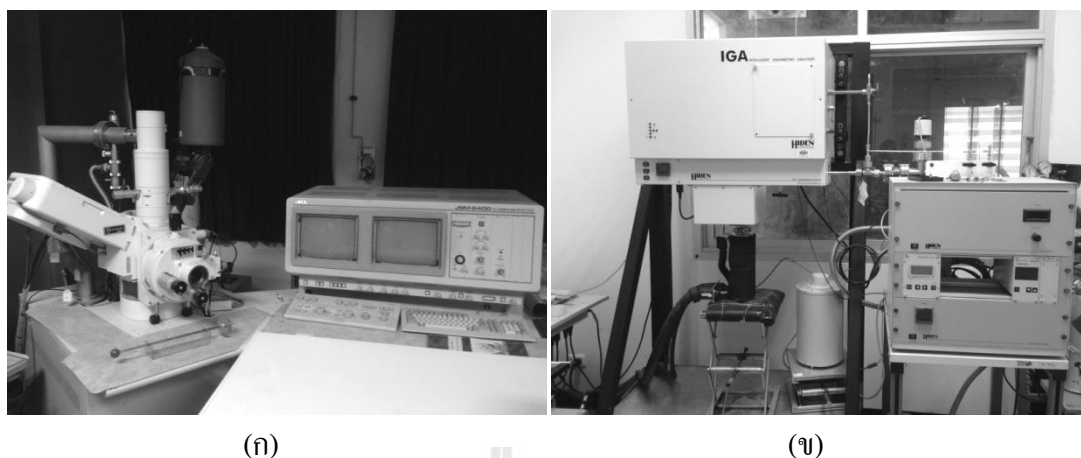
รูปที่ 3.3 เครื่องวิเคราะห์พื้นที่ผิวด้วยกล้องจุลทรรศน์อิเล็กตรอนไมโครสโคปแบบส่องกราด (ก) และเครื่องวิเคราะห์การดูดซับเชิงน้ำหนัก (ข)
