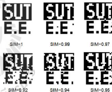
รูปที่ 5 ลายน้ำที่ตรวจจับได้ที่มีค่า SIM แตกต่างกัน
