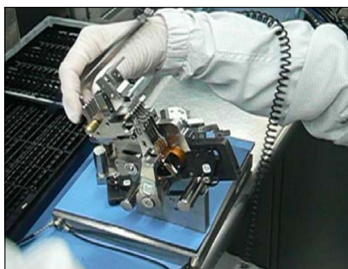
รูปที่ ก.7 แสดงการสวมหัวเข้ากับชุดหัวอ่านที่ประกอบเสร็จ
