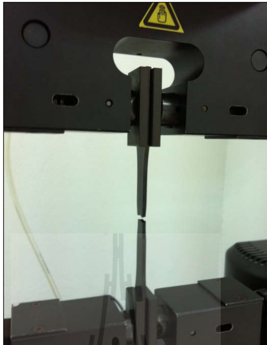
รูปที่ 4.13 แสดงผลการทดสอบการดึง Specimen ด้วยเครื่อง Universal Testing Machine
