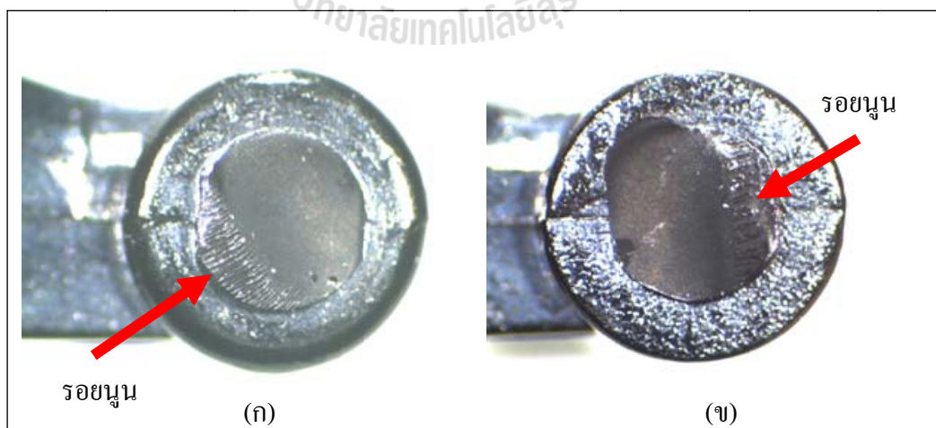
รูปที่ 4.3 แสดงลักษณะผิวหน้าที่เสียหายจากการหักของ Pin
