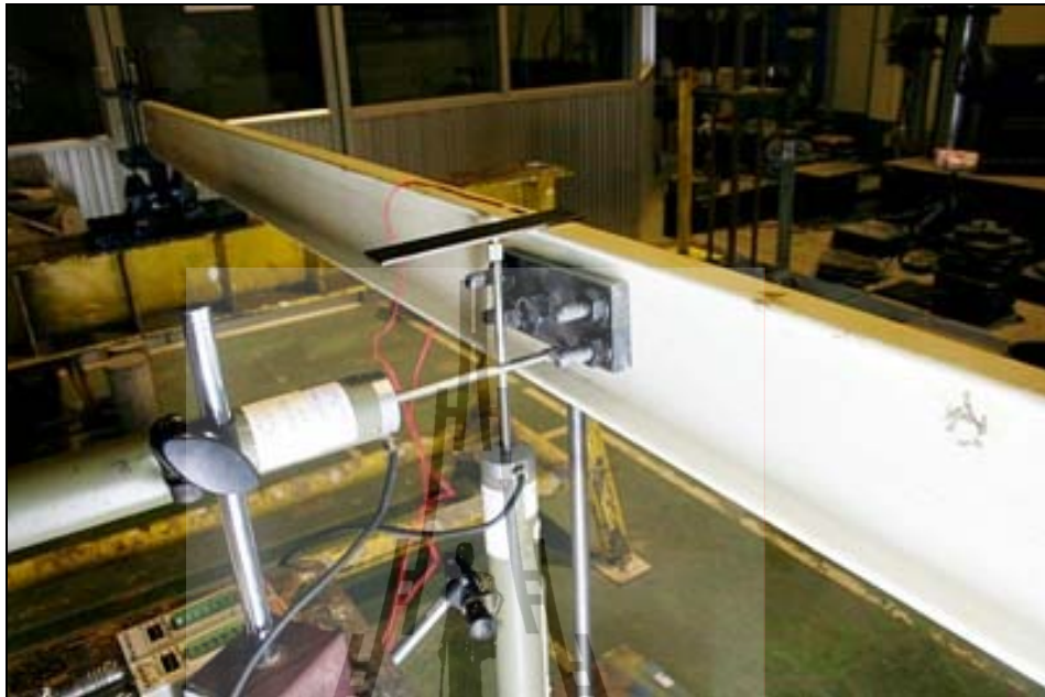
รูปที่ 3.15 การวัดระยะแอนตัวแนวตั้งและด้านข้างของตัวอย่างคาน PFRP ที่มีจุดรองรับแบบง่าย
