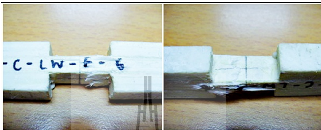
รูปที่ ก.23 การวิบัติของตัวอย่างทดสอบแรงอัดตามแนวแกนของเส้นใย
