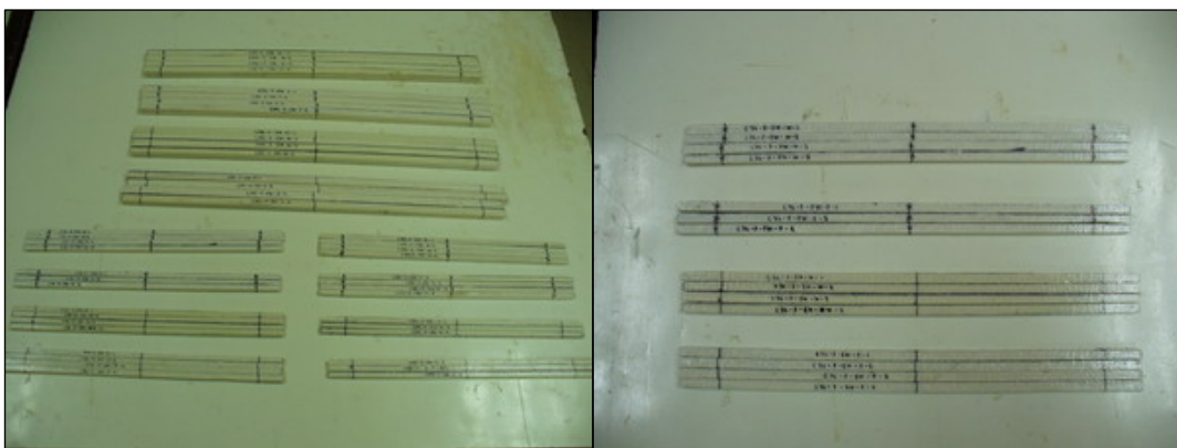
รูปที่ ก.28 ลักษณะตัวอย่างทดสอบสำหรับการทดสอบแรงค้ำตามแนวแกนของเส้นใย
