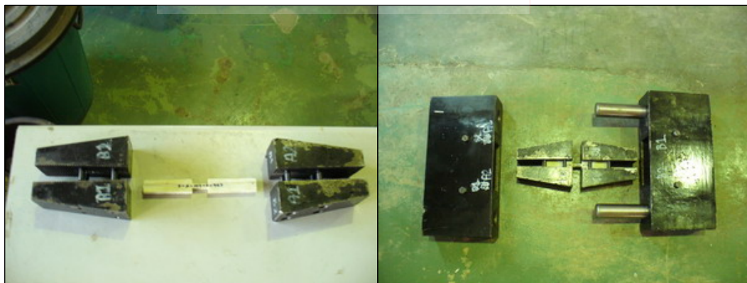
รูปที่ ก.20 Test fixture สำหรับการทดสอบแรงอัดตามแนวแกนของเส้นใย
