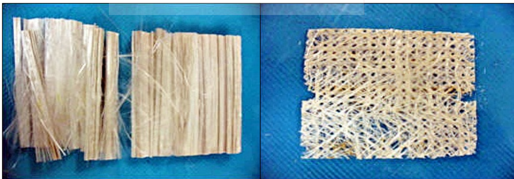
รูปที่ ก.12 ลักษณะการวางตัวของใยแก้วและแผ่นผิวของชิ้นส่วน PFRP
