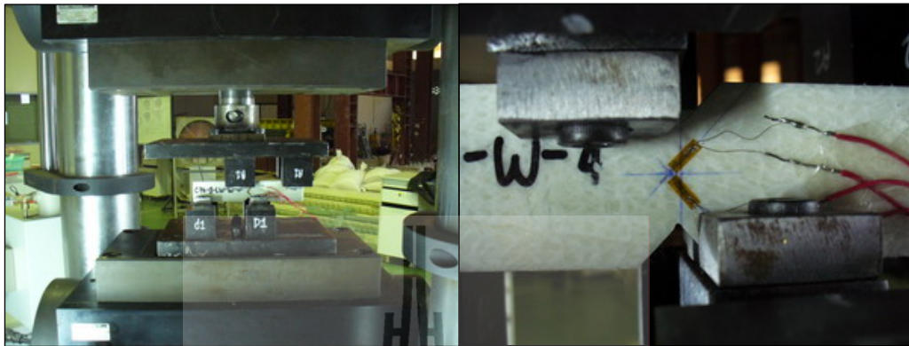
รูปที่ ก.37 การติดตั้งตัวอย่างสำหรับการทดสอบแรงเฉือนตามแนวแกนของเส้นใย
