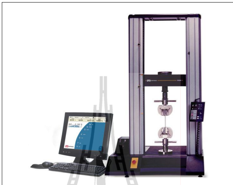
รูปที่ 2.7 แสดงการทดสอบแรงดึงด้วยเครื่องทดสอบอเนกประสงค์
