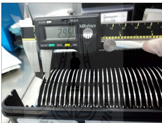
รูปที่ 4.11 ระยะห่างของแผ่นแม่เหล็กบันทึกข้อมูลที่แคบเพียง 3 มิลลิเมตร
