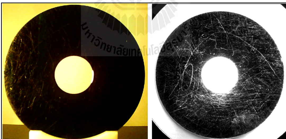
รูปที่ ก.28 ภาพที่ถ่ายจากกล้องที่ใช้ Ring light high angle (ซ้ายมือ) และภาพที่ถ่ายจากกล้องที่ใช้ Ring light low angle (ขวามือ)
