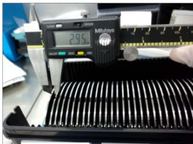
รูปที่ 1.2 พื้นที่ของการตรวจสอบแผ่นแม่เหล็กบันทึกข้อมูลที่แคบเพียง 3 มม.
