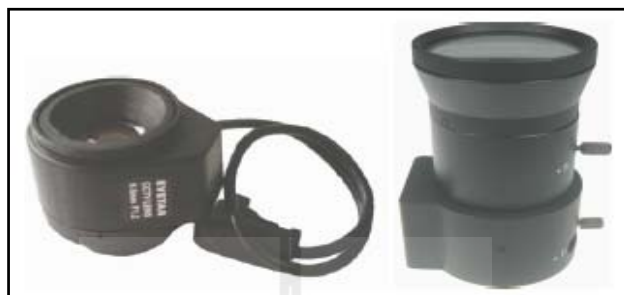
รูปที่ 2.18 Auto Iris lens ที่มาของภาพต้นฉบับ : www.telca.co.th/T%20pages/Intro%20CCTV/lens.pdf
