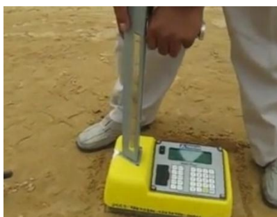
รูปที่ 2.45 การกดแท่งรังสีให้เลื่อนลงไปในรูเจาะให้ลึกตามที่ต้องการ โดยคลายล็อกกลไกที่แขนจับ หลังจากนั้นกดปุ่มคำสั่งให้เครื่องทำงาน
