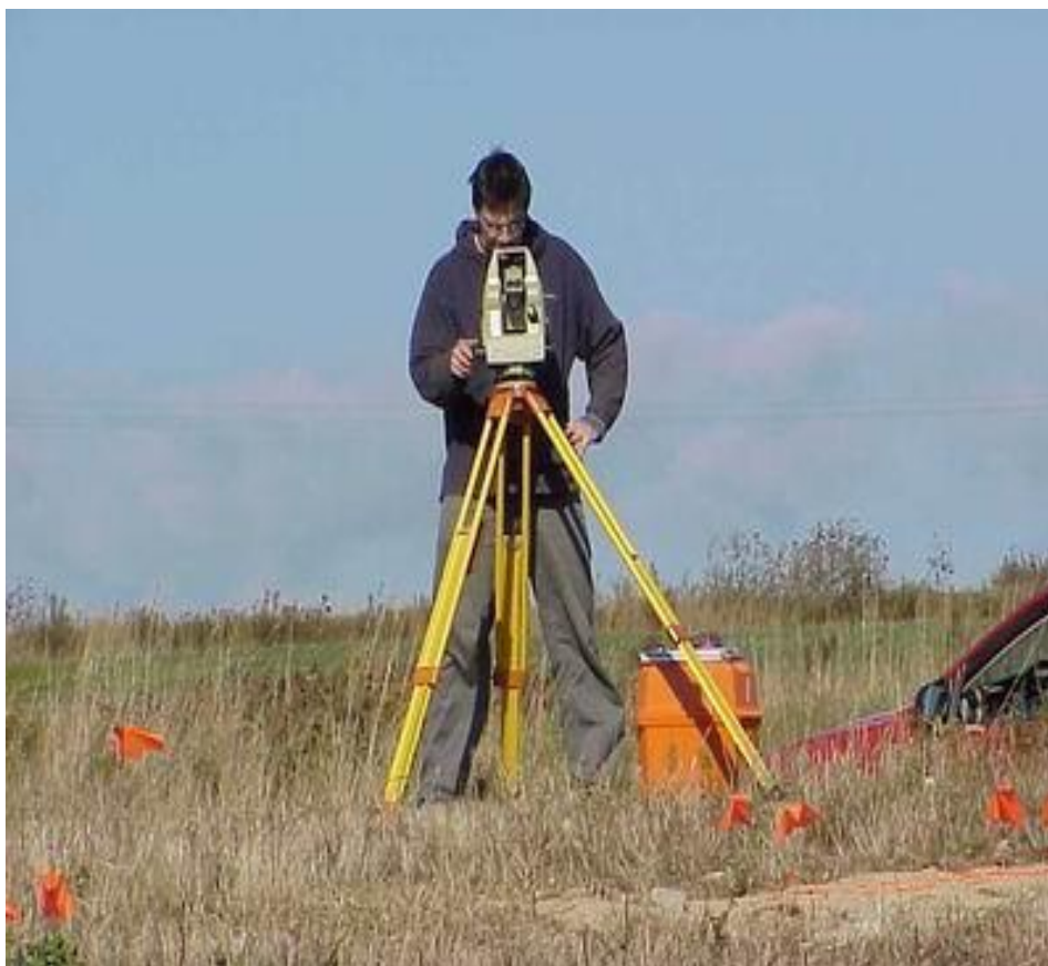
รูปที่ 3.4 กล้องสำรวจ
