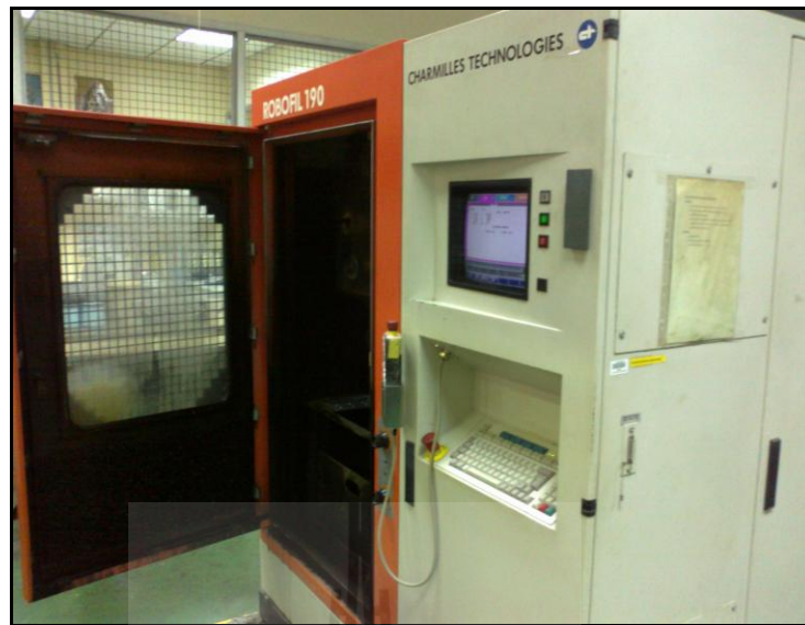
รูปที่ 3.4 เครื่องตัดชิ้นงานโลหะประเภท EDW WIRECUT
