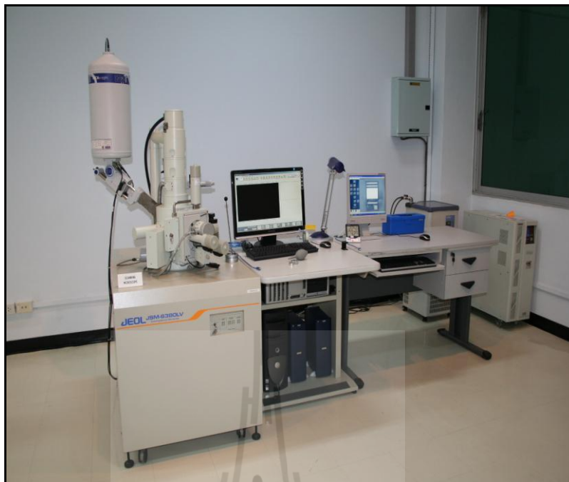
รูปที่ 3.17 กล้องจุลทรรศน์อิเล็กตรอนแบบส่องกราด
