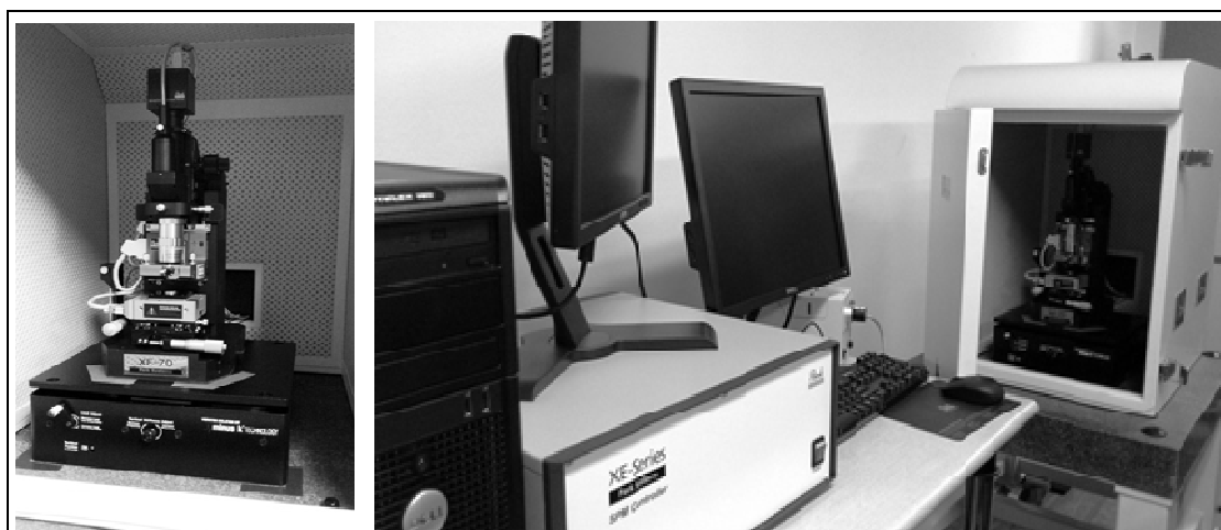
รูปที่ 3.9 เครื่อง Atomic force Microscope (AFM) รุ่น XE-70 ยี่ห้อ Park System
