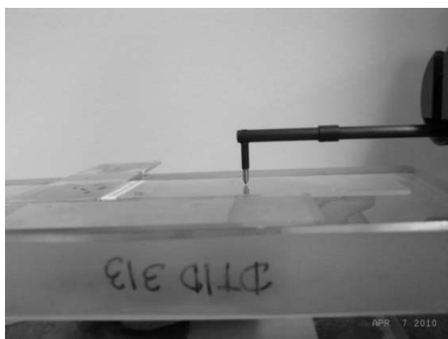
รูปที่ 3.8 แสดงวิธีการวัดความขรุขระพื้นผิว
