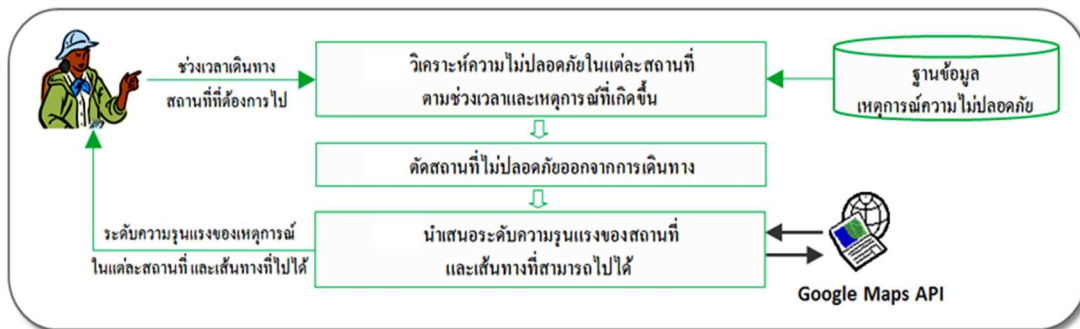
รูปที่ 3.8 ขั้นตอนวิเคราะห์ความไม่ปลอดภัยที่เกิดขึ้นของสถานที่ที่ต้องการไป
