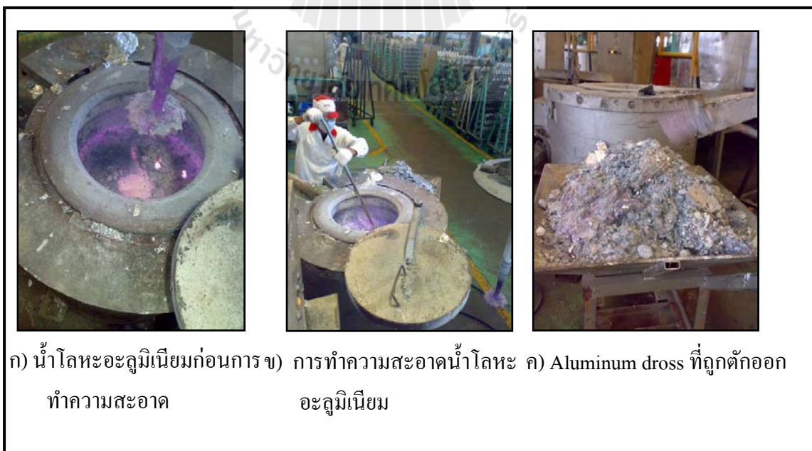
รูปที่ 3.7 แสดงขั้นตอนการทำความสะอาดอะลูมิเนียม
