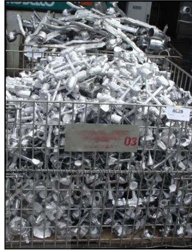
ข) ชั้นงาน Pipe inlet ที่มีข้อบกพร่อง
