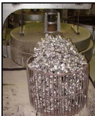
รูปที่ 3.17 ตะกร้าใส่ชิ้นงานสำหรับอบชุบความร้อน
