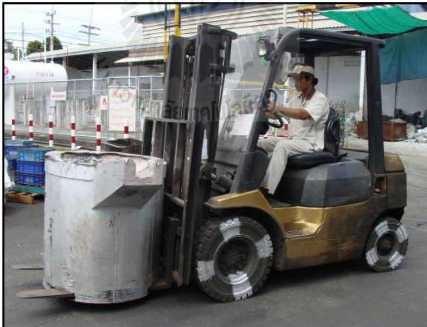
รูปที่ 3.6 ขั้นตอนการเคลื่อนย้ายน้ำโลหะหลอมเหลว
