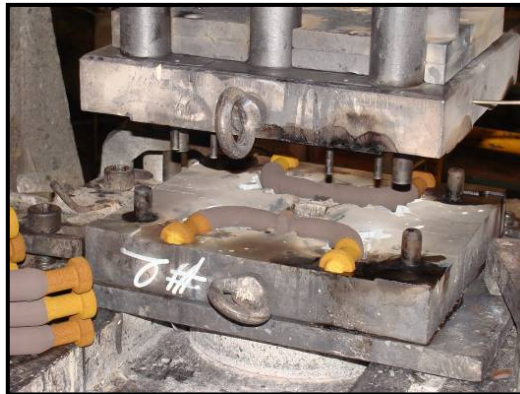
รูปที่ 3.14 ใส่วางสายไฟแบบลงในแม่พิมพ์โลหะ
