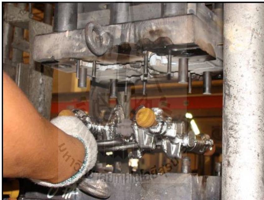
รูปที่ 3.15 นำชิ้นงานออกจากแม่พิมพ์โลหะ
