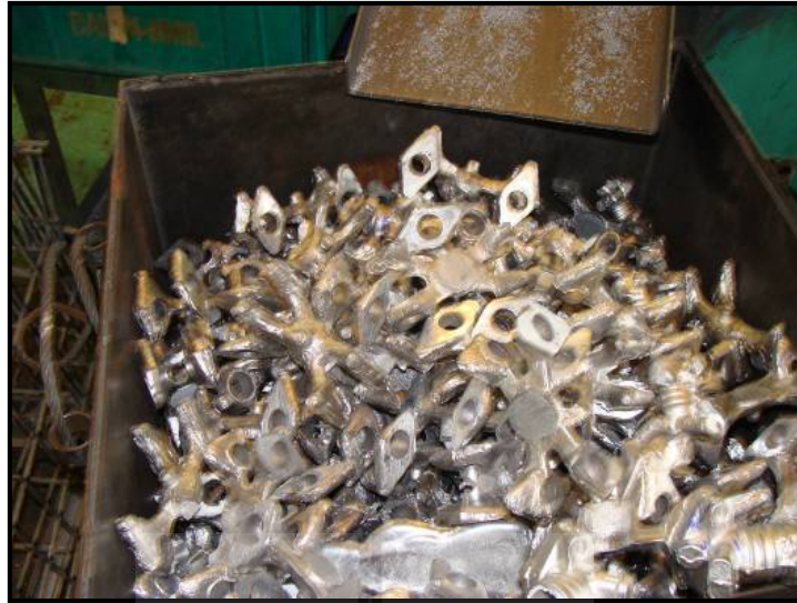
รูปที่ 3.20 เศษชิ้นส่วนงานเสีย สำหรับนำเข้าสู่กระบวนการหลอมใหม่
