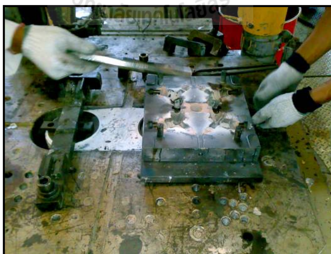
รูปที่ 3.11 การติดตั้งแม่พิมพ์โลหะก่อนกระบวนการผลิต
