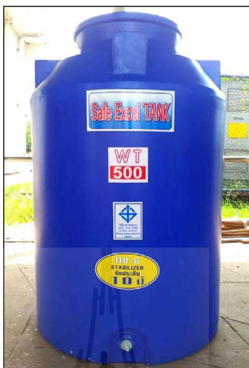
รูปที่ 4.20 ถังปฏิกรณ์สำหรับเตรียมน้ำสี
