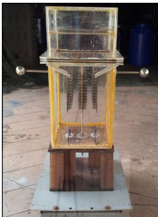
รูปที่ 4.9 ถังปฏิกรณ์อะคริลิกใสทรงสี่เหลี่ยมผืนผ้าสำหรับใส่ น้ำเสียในการบำบัด
