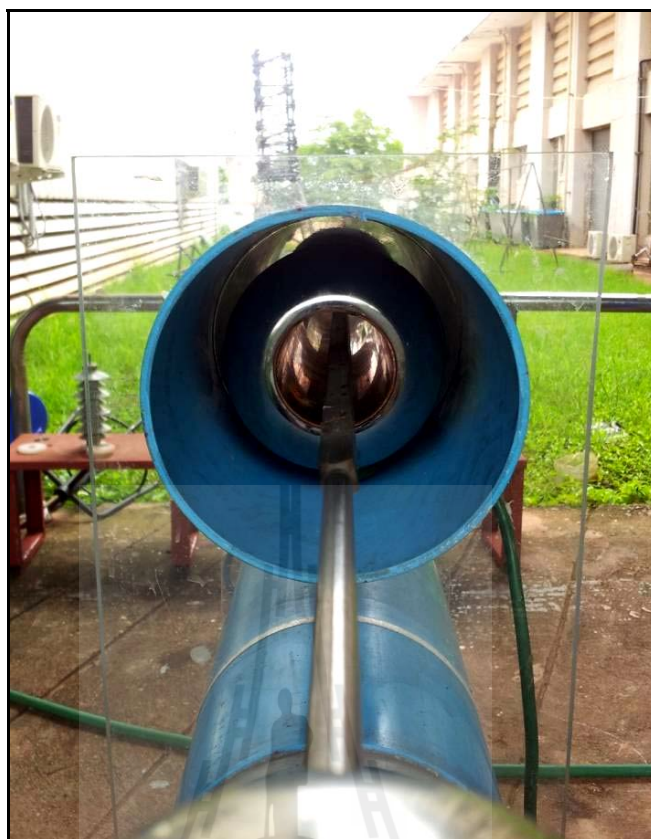
รูปที่ 4.17 การวางตัวของแท่งอิเล็กโทรดสแตนเลสภายในท่อทองแดง
