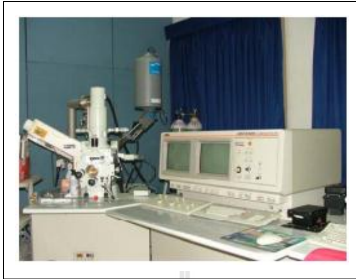
รูปที่ 3.21 กล้องจุลทรรศน์อิเล็กตรอนแบบส่องกราด (Scanning Electron Microscope, SEM)
