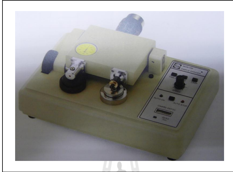
รูปที่ 3.29 เครื่อง dimple deep ของบริษัท GATAN
