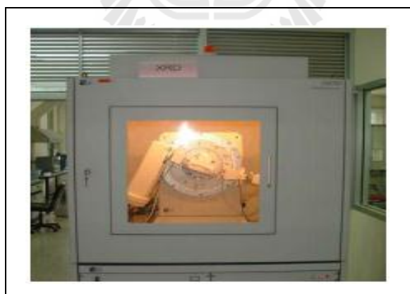
รูปที่ 3.10 เครื่องวิเคราะห์การเลี้ยวเบนของรังสีเอกซ์ (X-ray diffraction, XRD)
