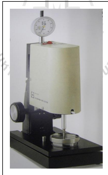
รูปที่ 3.25 เครื่องตัดความถี่สูง (ultrasonic disc cutter) ของบริษัท GATAN
