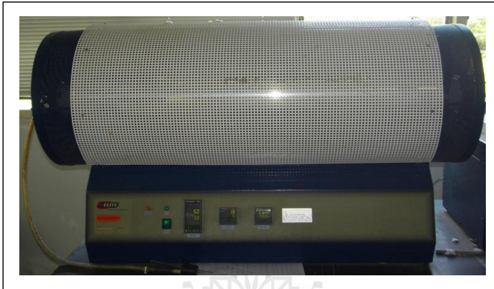
รูปที่ 3.7 แสดงเตาไฟฟ้าแบบท่อ (tube furnace)
