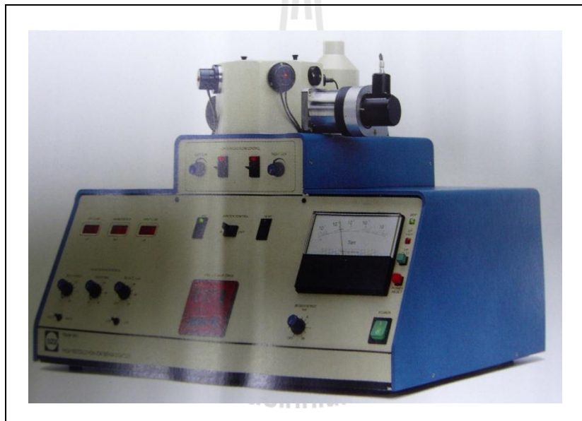
รูปที่ 3.32 เครื่องกัดผิวหน้าชิ้นงานด้วยไอออน (ion milling) ของบริษัทGATAN
