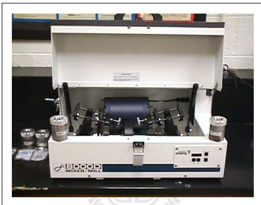
รูปที่ 3.6 เครื่องบดผสมแบบเชิงกล (SPEX mill)
