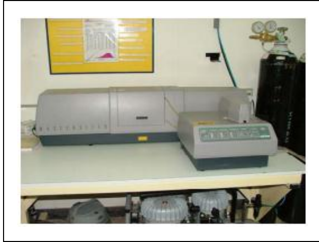
รูปที่ 3.9 เครื่อง particle size analyzer ของบริษัท Malvern Instrument Ltd.
