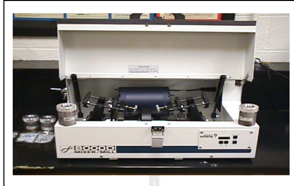
รูปที่ 2.5 เครื่องบดแบบเขย่า (SPEX mill)
