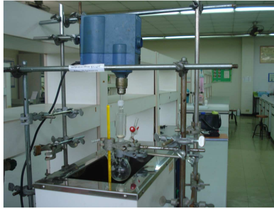
รูปที่ 3.1 การติดตั้งอุปกรณ์สำหรับการสังเคราะห์พอลิแลคติกแอซิดน้ำหนักโมเลกุลต่ำ
