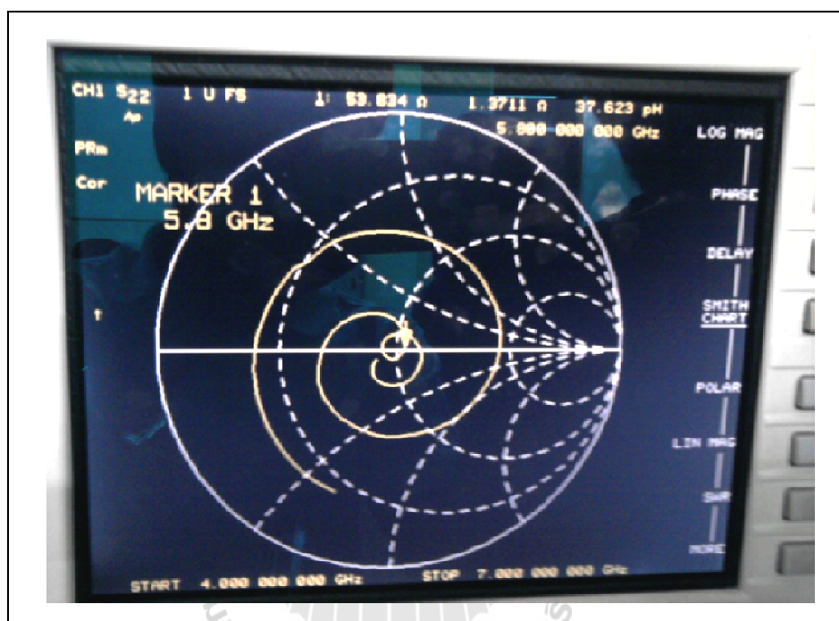
รูปที่ 5.8 ผลการวัดทดสอบค่าอิมพีแดนซ์ของช่องว่างแถบความถี่แม่เหล็กไฟฟ้าร่วมกับไดโพลพับตันแบบ
