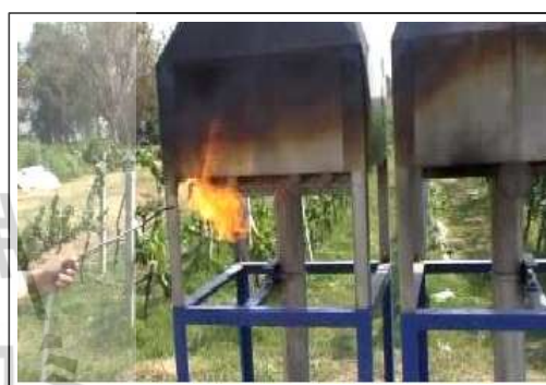
ซ. การทดสอบการลุกไหม้ของแก๊สเชื้อเพลิง
