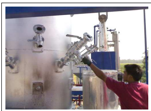
จ. เปิดวาล์วทางเข้าของอากาศรอบเตา
