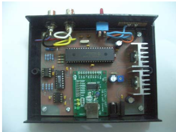
ภาพที่ 45 กล่องแปลงสัญญาณที่ประกอบเสร็จเรียบร้อยแล้ว
