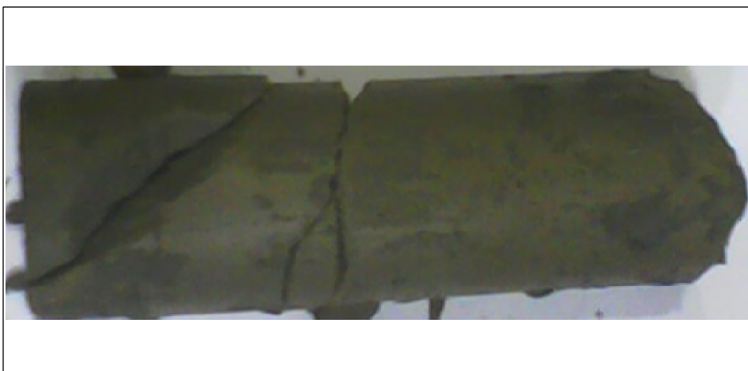
รูปที่ 4.14 การวิบัติของเสาเข็มดินซีเมนต์หลังจากทดสอบ
