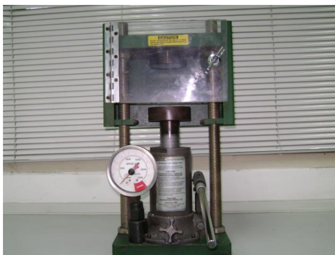
รูปที่ 3.7 เครื่องอัดแบบไฮดรอลิกแรงอัดขนาด 11 ตัน
