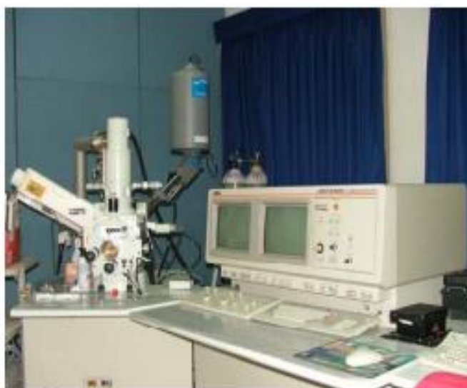
รูปที่ 3.12 กล้องจุลทรรศน์อิเล็กตรอนแบบส่องกราด
