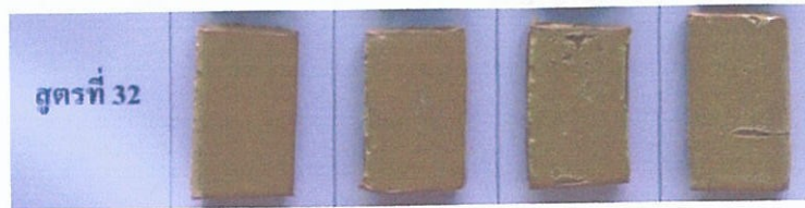
รูปที่ 6 เคลือบสีเหลือง เตรียมโดยอบผสม 3 ชั่วโมง เผาที่อุณหภูมิ 1000°C ยืนไฟ 2 ชั่วโมง
