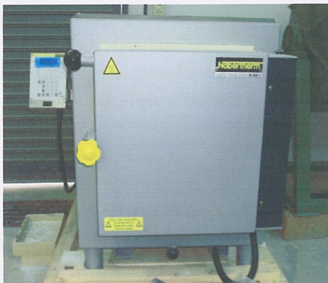
รูปที่ 2.27 เตาเผาชิ้นงานสำหรับเผา biscuit
