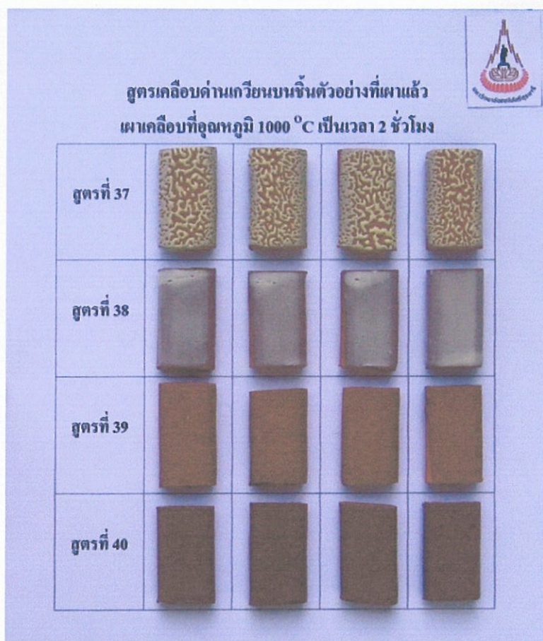
รูปที่ 2.16 สูตรเคลือบค่านเกวียน 37-40 บนชิ้นตัวอย่างที่เผา biscuit ก่อนชุบเคลือบ หลังจากชุบเคลือบแล้วเผาเคลือบที่อุณหภูมิ 1000°C ขึ้นไฟ 2 ชั่วโมง ในเตาไฟฟ้า
