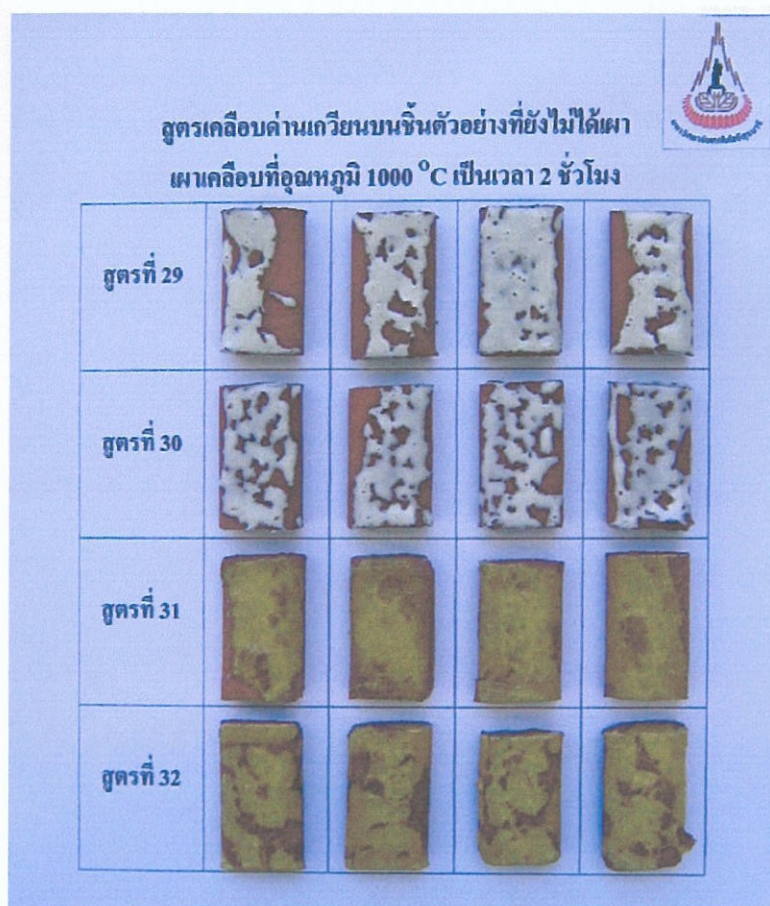
รูปที่ 2.19 สูตรเคลือบค่านเกวียน 29-32 บนจีนตัวอย่างที่ยังไม่ได้เผา biscuit ก่อนชุบเคลือบ หลังจากชุบเคลือบแล้วเผาเคลือบที่อุณหภูมิ 1000 °C ยืนไฟ 2 ชั่วโมง ในเตาไฟฟ้า
