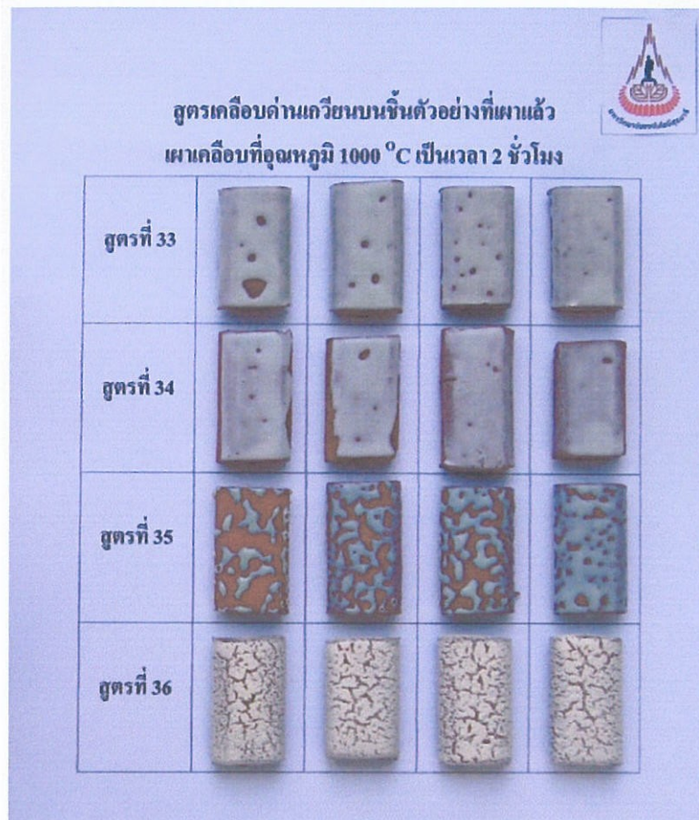
รูปที่ 2.15 สูตรเคลือบด้านเกวียน 33-36 บนชิ้นตัวอย่างที่เผา biscuit ก่อนชุบเคลือบ หลังจากชุบเคลือบแล้วเผาเคลือบที่อุณหภูมิ 1000°C ขึ้นไฟ 2 ชั่วโมง ในเตาไฟฟ้า
