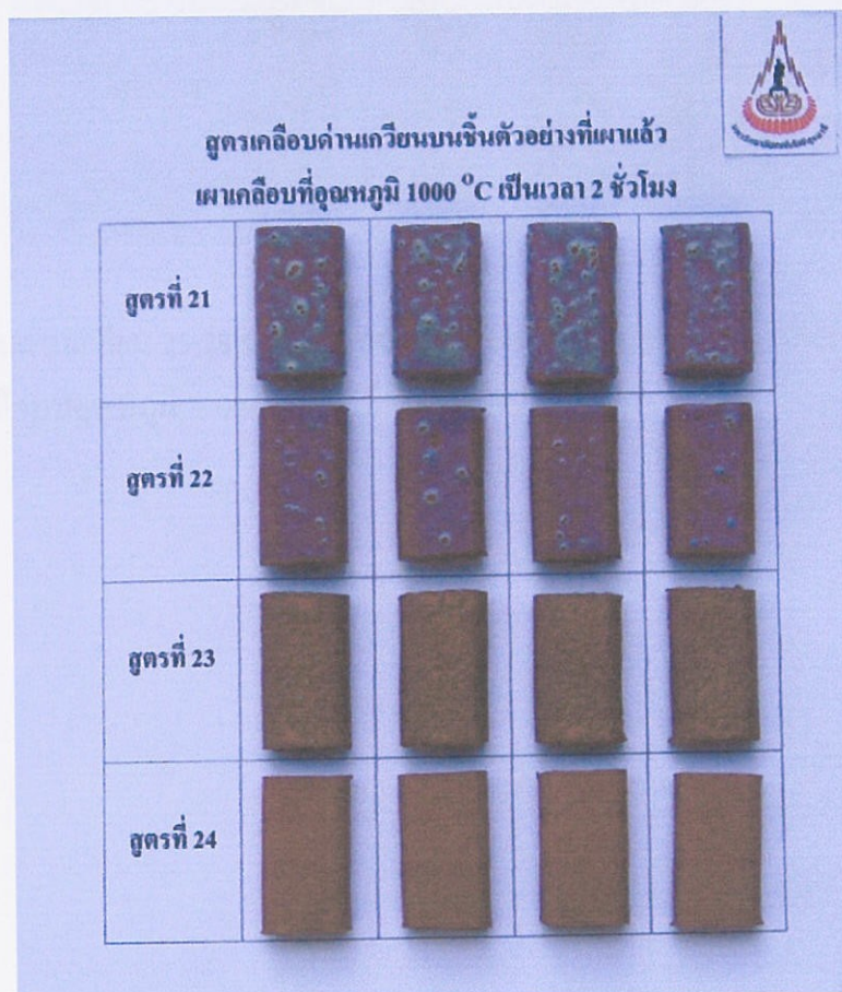
รูปที่ 2.12 สูตรเคลือบค่านเกวียน 21-24 บนชิ้นตัวอย่างที่เผา biscuit ก่อนชุบเคลือบ หลังจากชุบเคลือบแล้วเผาเคลือบที่อุณหภูมิ 1000°C ขึ้นไฟ 2 ชั่วโมง ในเตาไฟฟ้า
