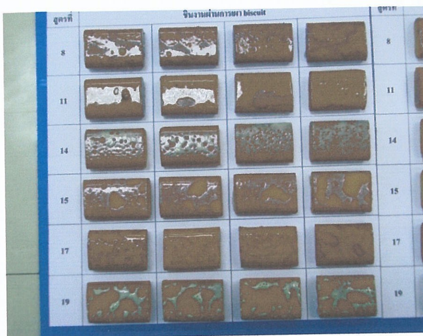
รูปที่ 2.30 ชิ้นตัวอย่างที่ผ่านการเผา biscuit ก่อนชุบเคลือบและหลังจากชุบเคลือบแล้วนำไปเผาในเตาไฟฟ้าที่อุณหภูมิ 1000^{\circ}\text{C} ยืนไฟ 2 ชั่วโมง
