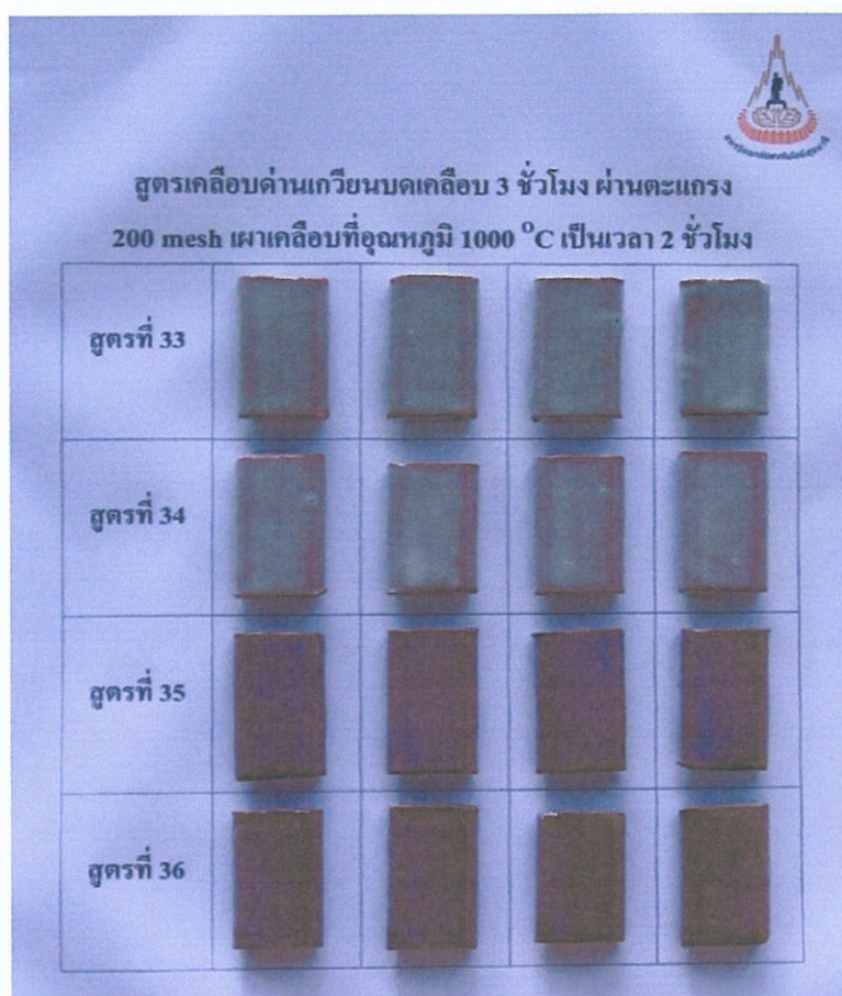
รูปที่ 2.25 สูตรเคลือบด้านเหนียว 33-36 บคเป็นเวลา 3 ชั่วโมง ร้อนผ่านตะแกรง 200 เมช บนจิ้นตัวอย่างที่เผา biscuit ก่อนชุบเคลือบ หลังจากชุบเคลือบแล้วเผาเคลือบที่อุณหภูมิ 1000°C ขึ้นไฟ 2 ชั่วโมง ในเตาไฟฟ้า
