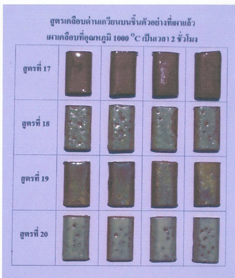
รูปที่ 2.8 สูตรเคลือบค่านเกวียน 17-20 บนชิ้นตัวอย่างที่เผา biscuit ก่อนชุบเคลือบ หลังจากชุบเคลือบแล้ว เผาเคลือบที่อุณหภูมิ 1000°C ยืนไฟ 2 ชั่วโมง ในเตาไฟฟ้า
