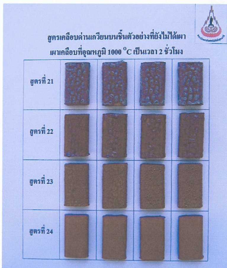
รูปที่ 2.17 สูตรเคลือบค่านเกวียน 21-24 บนชิ้นตัวอย่างที่ยังไม่ได้เผา biscuit ก่อนชุบเคลือบ หลังจากชุบเคลือบแล้วเผาเคลือบที่อุณหภูมิ 1000 °C ขึ้นไฟ 2 ชั่วโมง ในเตาไฟฟ้า
