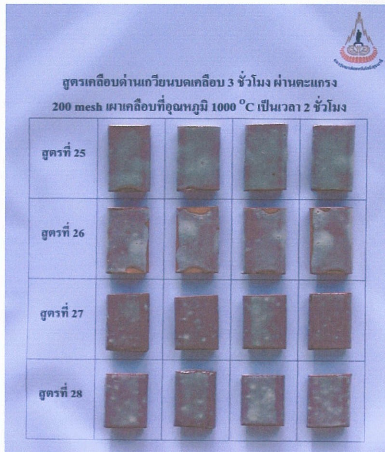
รูปที่ 2.23 สูตรเคลือบด้านเกวียน 25-28 บดเป็นเวลา 3 ชั่วโมง ร้อนผ่านตะแกรง 200 เมช บนจีนตัวอย่างที่ เเผา biscuit ก่อนชุบเคลือบ หลังจากชุบเคลือบแล้วเผาเคลือบที่อุณหภูมิ 1000°C ขึ้นไฟ 2 ชั่วโมง ในเตาไฟฟ้า
