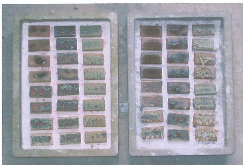
รูปที่ 2.39 ชิ้นตัวอย่างที่ผ่านและไม่ผ่านการเผา biscuit ก่อนชุบเคลือบ หลังจากชุบเคลือบแล้วเผาเคลือบที่บริเวณไฟอ่อนในเตาฟืน ก) สูตรเคลือบที่ใช้บอแรกซ์เป็นส่วนผสม ข) สูตรเคลือบที่ใช้ TOP-BOR เป็นส่วนผสม
