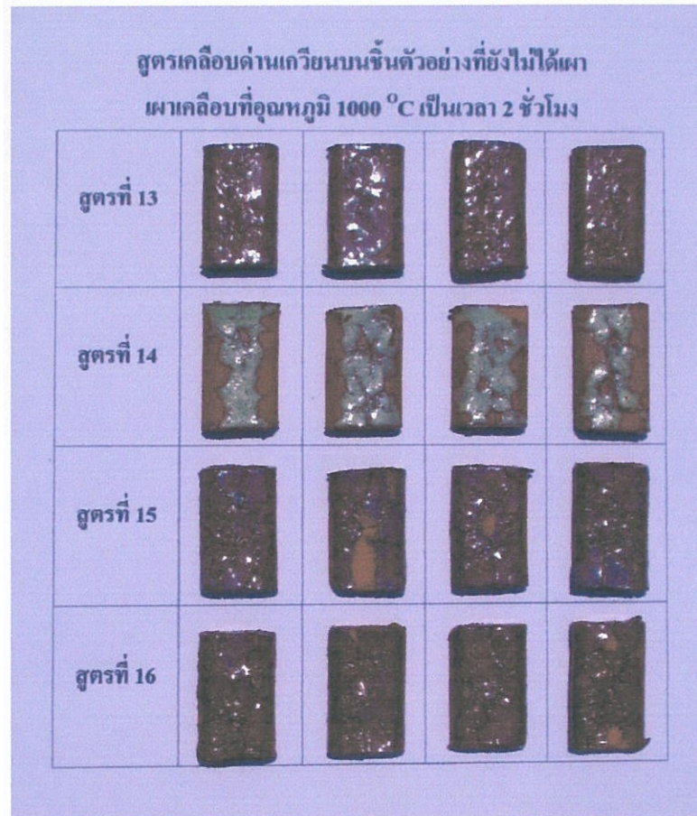
รูปที่ 2.10 สูตรเคลือบด้านเกวียน 13-16 บนจีนตัวอย่างที่ยังไม่ได้เผา biscuit ก่อนชุบเคลือบ หลังจากชุบเคลือบแล้วเผาเคลือบที่อุณหภูมิ 1000°C ขึ้นไฟ 2 ชั่วโมง ในเตาไฟฟ้า
