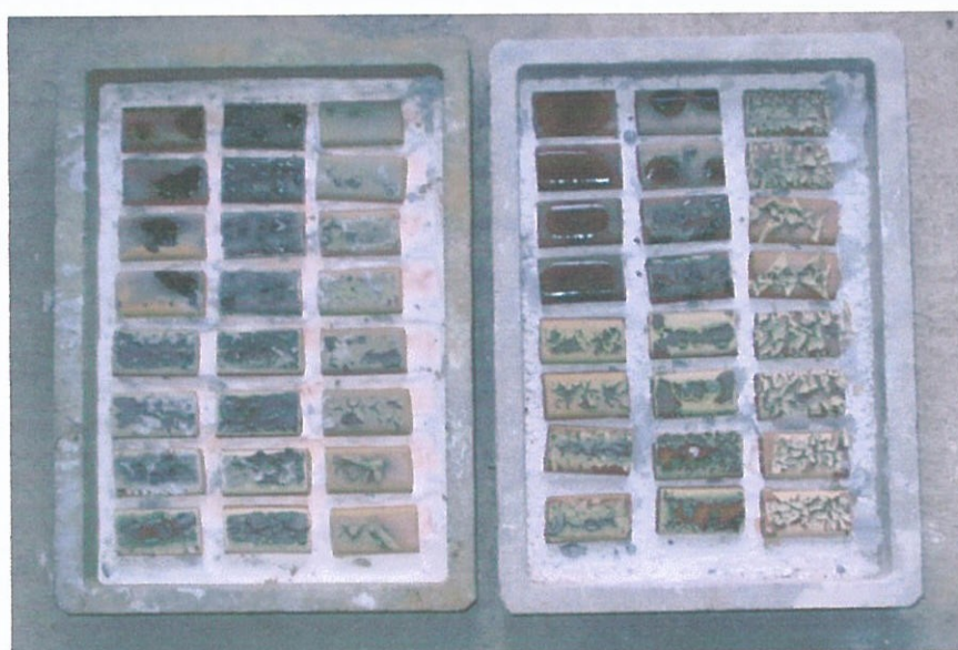
รูปที่ 2.39 ชิ้นตัวอย่างที่ผ่านและไม่ผ่านการเผา biscuit ก่อนชุบเคลือบ หลังจากชุบเคลือบแล้วเผาเคลือบที่บริเวณไฟอ่อนในเตาฟืน ก) สูตรเคลือบที่ใช้บอแรกซ์เป็นส่วนผสม ข) สูตรเคลือบที่ใช้ TOP-BOR เป็นส่วนผสม
