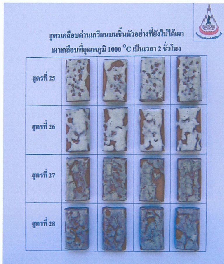
รูปที่ 2.18 สูตรเคลือบด้านเกวียน 25-28 บนจีนตัวอย่างที่ยังไม่ได้เผา biscuit ก่อนชุบเคลือบ หลังจากชุบเคลือบแล้วเผาเคลือบที่อุณหภูมิ 1000°C ขึ้นไฟ 2 ชั่วโมง ในเตาไฟฟ้า
