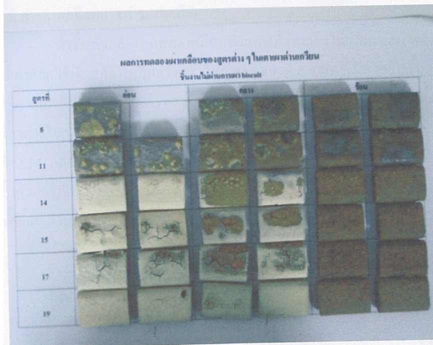
รูปที่ 2.33 ชิ้นตัวอย่างที่ไม่ผ่านการเผา biscuit ก่อนชุบเคลือบและหลังจากชุบเคลือบแล้วนำไปเผาในเตาฟืนที่ตำบลด่านเกวียน
