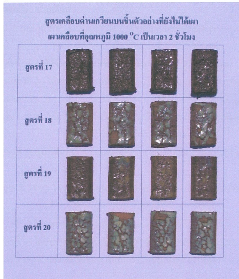
รูปที่ 2.11 สูตรเคลือบด้านกวียน 17-20 บนชิ้นตัวอย่างที่ยังไม่ได้เผา biscuit ก่อนชุบเคลือบ หลังจากชุบเคลือบแล้วเผาเคลือบที่อุณหภูมิ 1000°C ขึ้นไฟ 2 ชั่วโมง ในเตาไฟฟ้า
