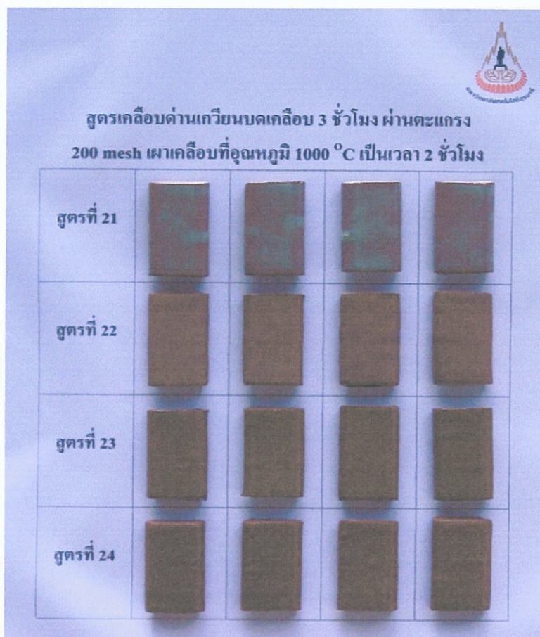
รูปที่ 2.22 สูตรเคลือบด้านเกวียน 21-24 บดเป็นเวลา 3 ชั่วโมง ร้อนผ่านตะแกรง 200 เมช บนจีนตัวอย่างที่ เผา biscuit ก่อนชุบเคลือบ หลังจากชุบเคลือบแล้วเผาเคลือบที่อุณหภูมิ 1000°C ขึ้นไฟ 2 ชั่วโมง ในเตาไฟฟ้า
