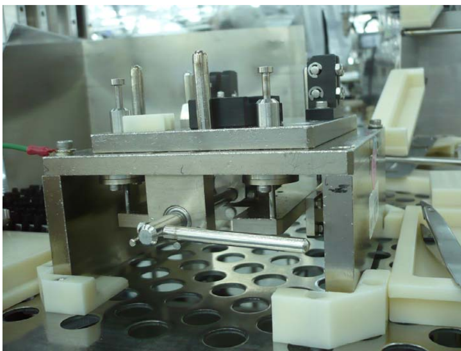
รูปที่ 3.2 ชุดจับยึดชิ้นงานของกระบวนการถอด HSA/VCM โดยมนุษย์
