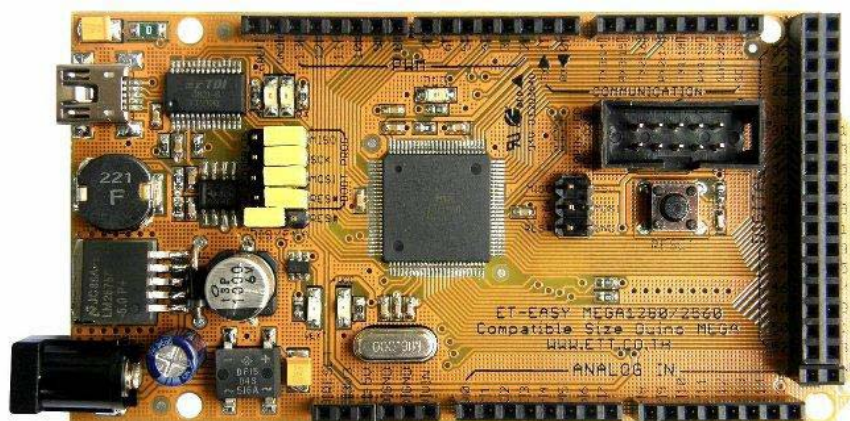
รูปที่ 3.20 บอร์ด ET-EASY MEGA1280 (DUINO MEGA) ใช้ชิพรุ่น ATMEGA 1280
