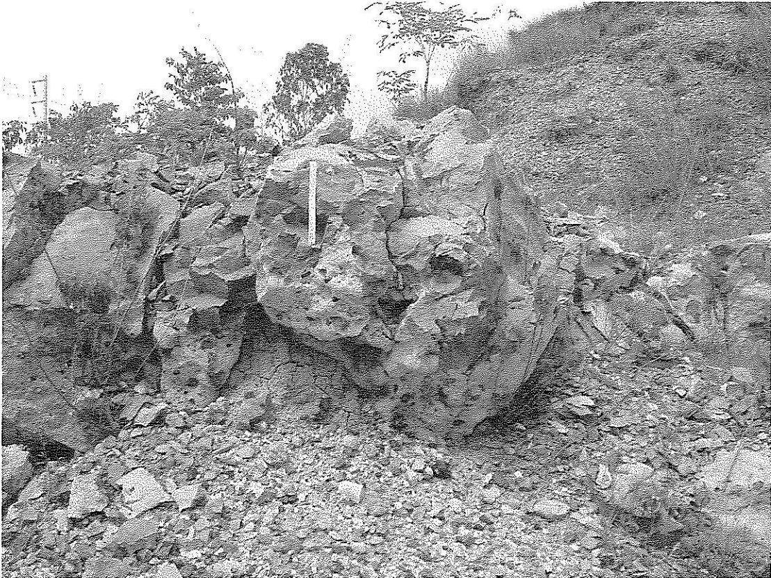
รูปที่ 28 ชั้น silcrete วางตัวอยู่ระหว่าง Unit II และ Unit III จุดสำรวจ 16
