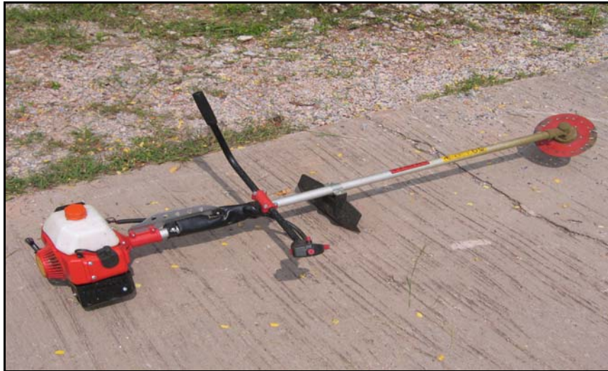
รูปที่ 3.7 เครื่องตัดหญ้าแบบสายสะพายแบบข้อแข็ง
