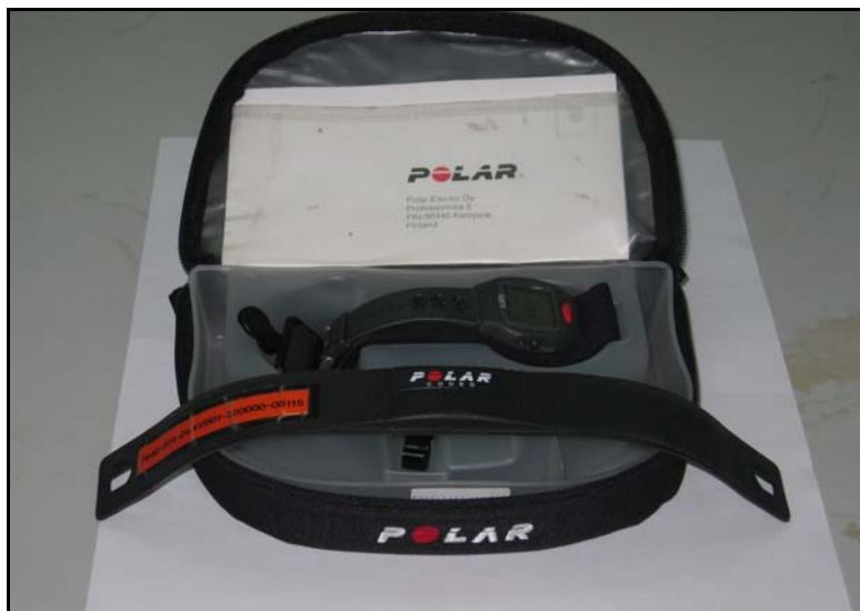
รูปที่ 3.4 เครื่องมือวัดอัตราการเต้นของหัวใจ
