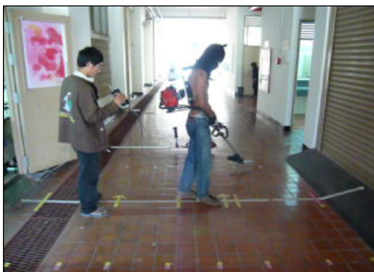
รูปที่ 3.12 การเหวี่ยงงานโบริมิดเครื่องตัดหญ้าแบบสายสะพายข้ออ่อนไปยังตำแหน่งที่กำหนด
