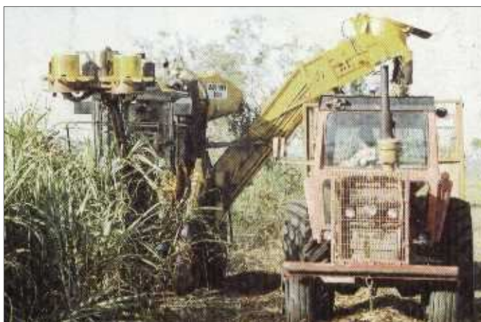
รูปที่ 2.2 การเก็บเกี่ยวด้วยเครื่องจักรชนิดตัดเป็นท่อน ๆ
