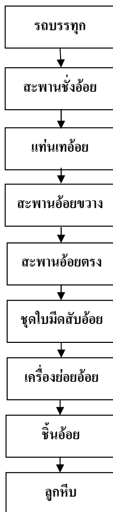
รูปที่ 2.3 แผนภาพแสดงการเตรียมอ้อยก่อนเข้าหีบ
