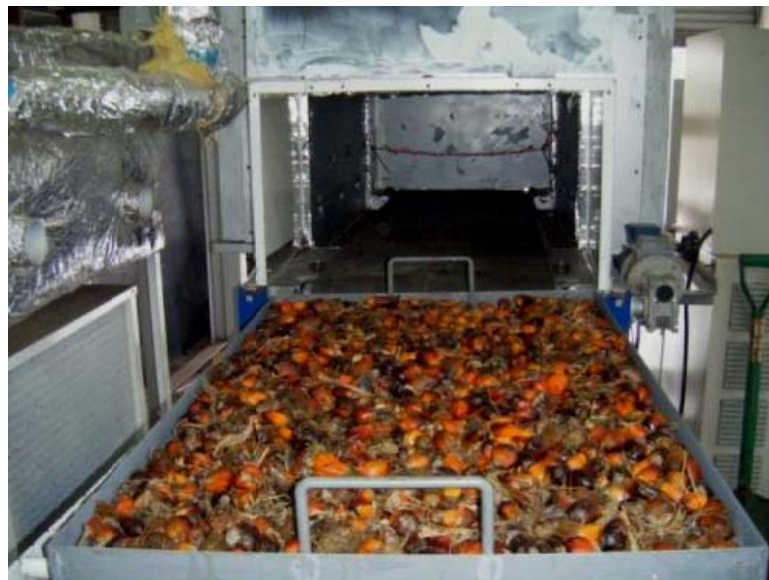
รูปที่ 4.16 การทดลองนึ่งผลปาล์มน้ำมันด้วยแผ่นตะแกรงเหล็ก 1 ชั้น
