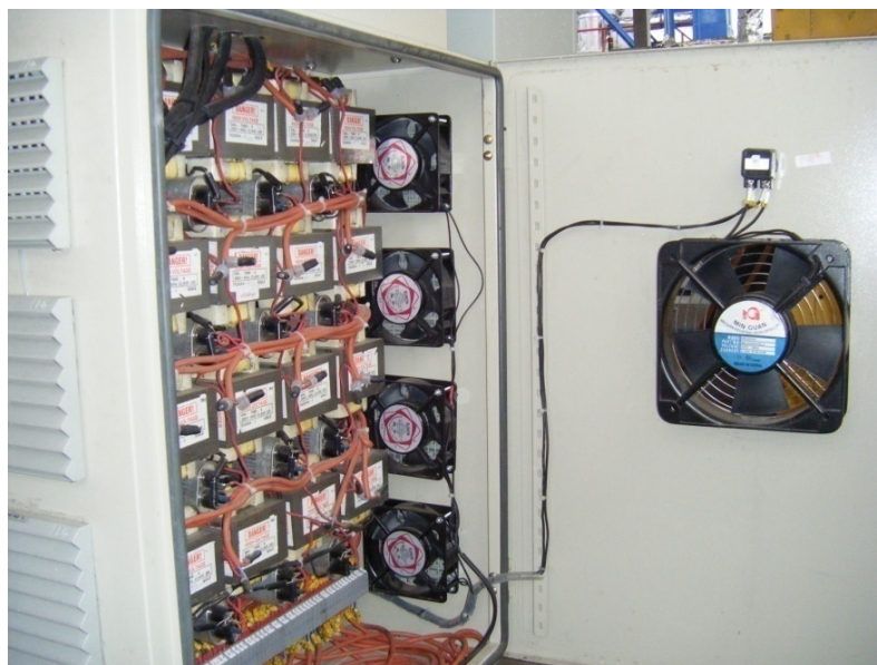
รูปที่ 4.10 ตู้หม้อแปลงของเตาอบไมโครเวฟแบบสายพาน
