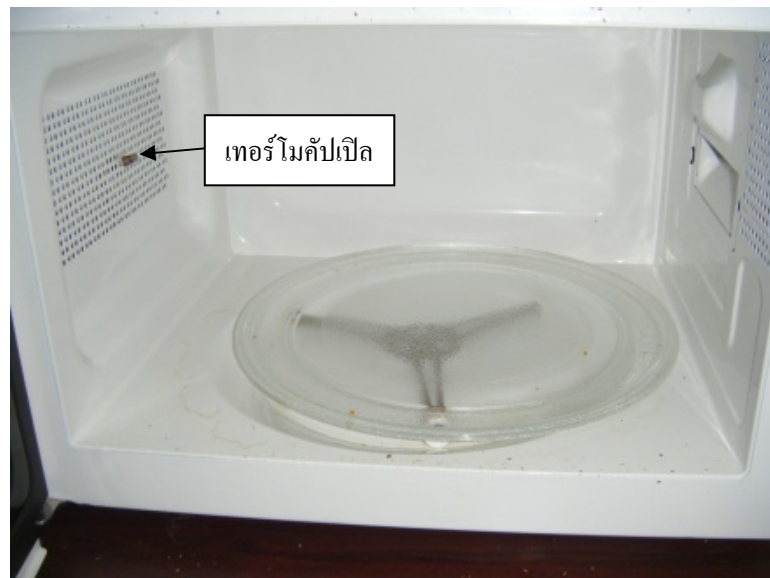
รูปที่ 3.5 ลักษณะการติดตั้งเทอร์โมคัปเปิลภายในห้องอบของเตาอบไมโครเวฟแบบครัวเรือน
