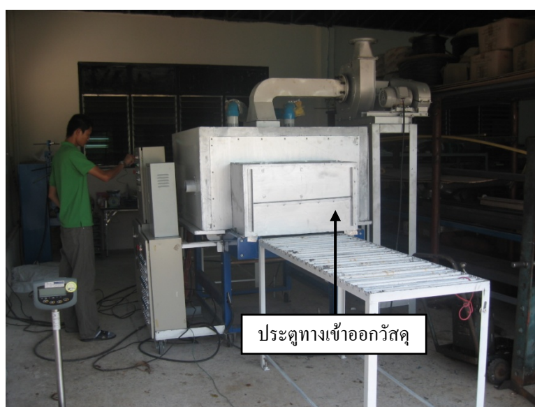
รูปที่ 4.2 ประตูทางเข้าออกวัสดุของเตาอบไมโครเวฟแบบสายพาน
