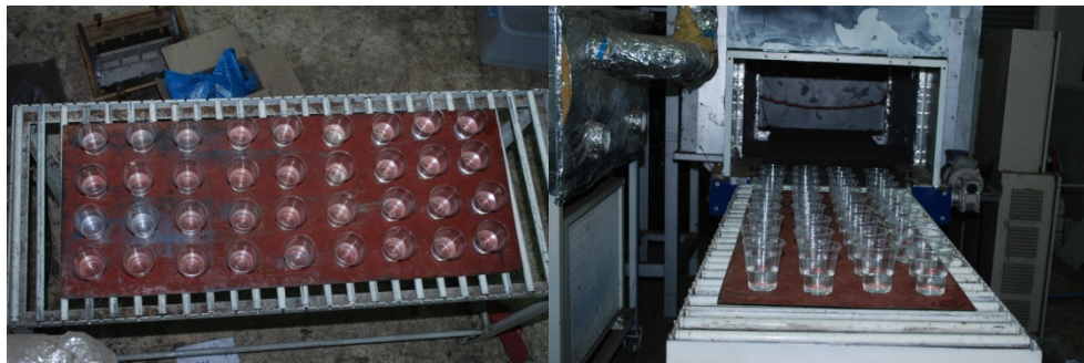
รูปที่ 4.12 การตรวจสอบการกระจายตัวของคลื่นของเตาอบไมโครเวฟแบบสายพาน
