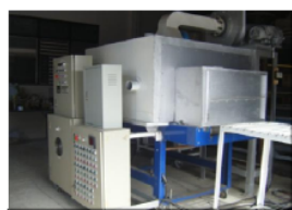
ภาพที่ 2 เตาอบไมโครเวฟแบบสายพาน(พัฒนาโดย มทส)
