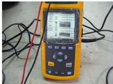
จ) เครื่องวัดกำลังไฟฟ้า
