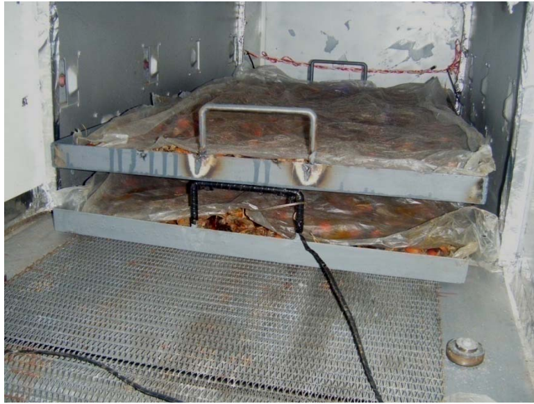
รูปที่ 4.15 การทดลองนึ่งผลปาล์มน้ำมันด้วยแผ่นตะแกรงเหล็ก 2 ชั้น
