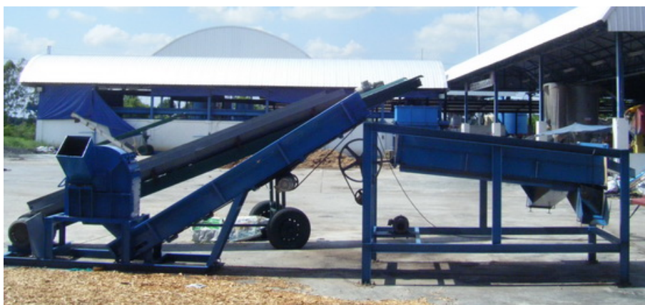
รูปที่ 3.1 เครื่องสับและคัดแยกที่ใช้ในการเตรียมเชื้อเพลิง
