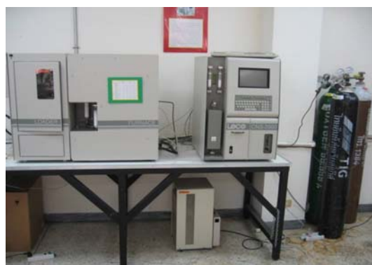
ง. เครื่อง CHNS Elemental Analyzer (วิเคราะห์ปริมาณธาตุ C H N S)
