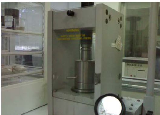
จ. เครื่องเตรียมตัวอย่างชีวมวล สำหรับนำไปวิเคราะห์กับเครื่อง EDXRF
