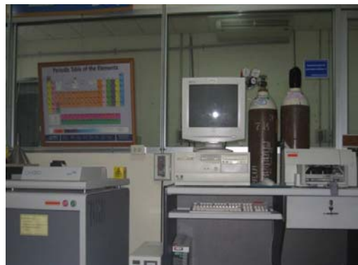
ฉ. เครื่อง EDXRF (วิเคราะห์ปริมาณธาตุ Cd Cu Pb Fe Zn Cl)
