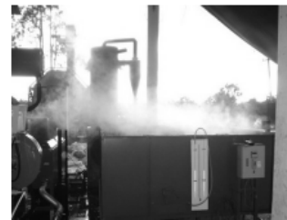
ภาพที่ 2 การทดสอบอบแห้งเชื้อเพลิงชีวมวลโดยใช้ความร้อนจากไอเสียเครื่องยนต์ผลิตไฟฟ้า
