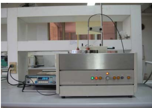
ค. เครื่อง Bomb Calorimeter (วิเคราะห์ค่าความร้อน)
