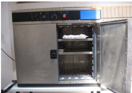
ก. เตาอบ Hot Air Oven (วิเคราะห์ความชื้น)
