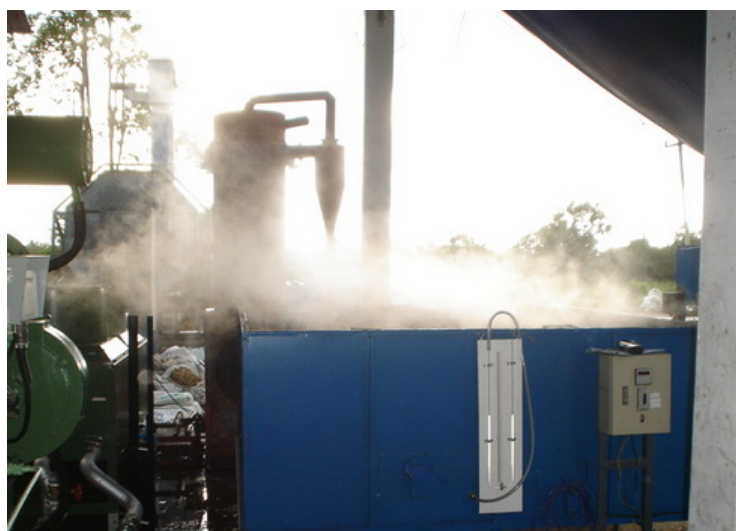
รูปที่ 4.5 ศึกษาการอบแห้งเชื้อเพลิงชีวมวลโดยใช้ความร้อนจากไอเสียเครื่องยนต์ผลิตไฟฟ้า
