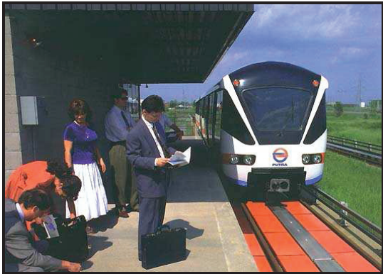
ภาพที่ 6 การจ่ายไฟด้วยรางที่ 3 ให้กับ High floor-LRV
