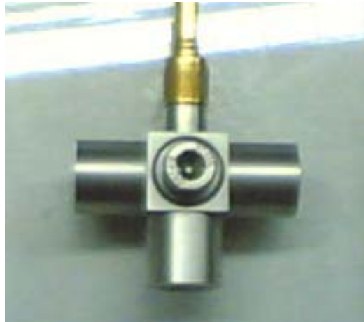
รูปที่ จ.2 ภาพถ่ายของอุปกรณ์ตัวตรวจวัดความเร่งของบริษัท Kistler รุ่น 8792A
