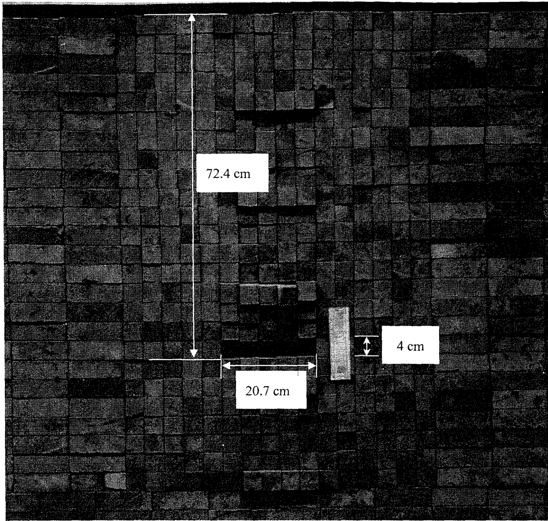
รูปที่ 6.2 ตัวอย่างของแบบจำลองอุโมงค์ในมวลหินที่ระดับความลึกปานกลาง ใช้ตัวอย่างหินขนาด 4×4×4 เซนติเมตร เพื่อจำลองระยะห่างระหว่างรอยแตกในแนวตั้ง เท่ากับ 4 เซนติเมตร
