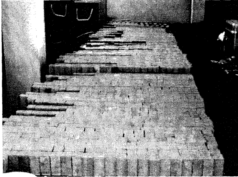
รูปที่ 3.1 ตัวอย่างหินทราย หมวดหิน ภูเขาณ ประมาณ 1,000 ก้อน จัดเตรียมเพื่อทำการทดสอบ โดยมีขนาด 4×4×4 เซนติเมตร 4×4×8 เซนติเมตร และ 4×4×12 เซนติเมตร
