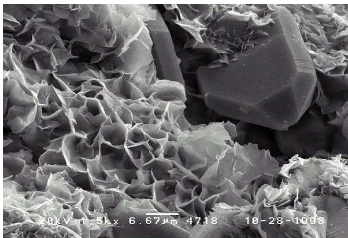
รูปที่ 2.2 ภาพขยายพื้นที่ผิวของแร่ดินมอนต์มอริลโลไนต์ ที่ถ่ายจาก SEM (Scanning Electron Micrograph) (OMNI Laboratories, Inc., www, 1990)
