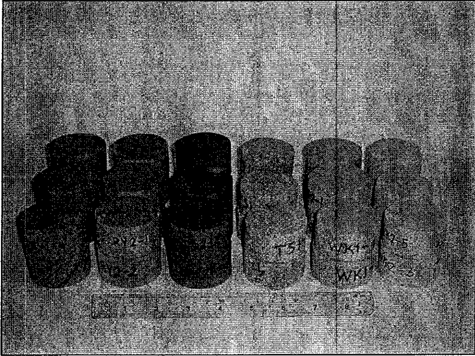
รูปที่ 5.11 ตัวอย่างหินทราย หินทรายแป้ง และหินชีสต์ ขนาดเส้นผ่าศูนย์กลาง 50 มิลลิเมตร ยาว 25 มิลลิเมตร ถูกจัดเตรียมเพื่อการทดสอบค่ามุมเสียดทานพื้นฐาน
