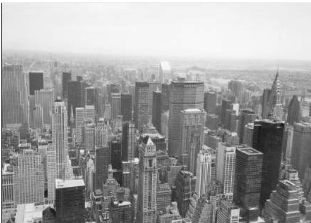
รูปที่ 3.9 สภาพภูมิประเทศ A ศูนย์กลางเมืองขนาดใหญ่ (ASCE, 2000)
