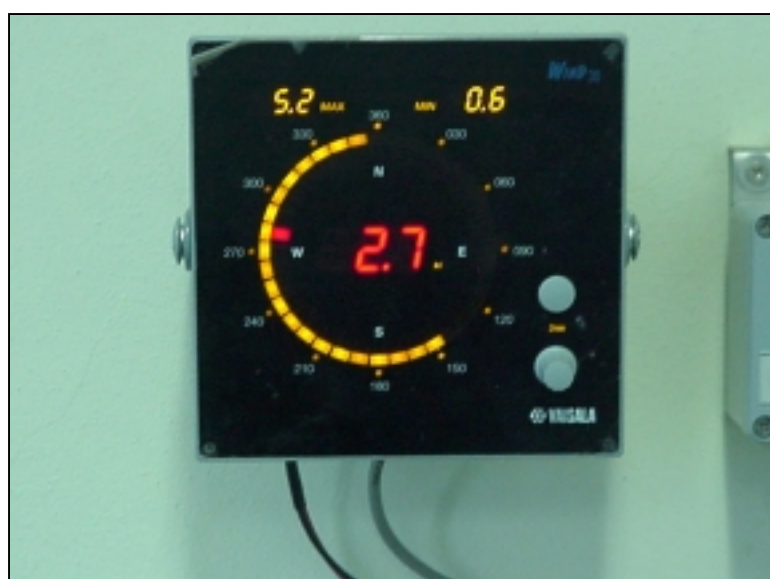
รูปที่ 2.11 หน้าปัดแสดงความเร็วลมและทิศทางลมเครื่องมือวัดความเร็วลมแบบอัตโนมัติ
