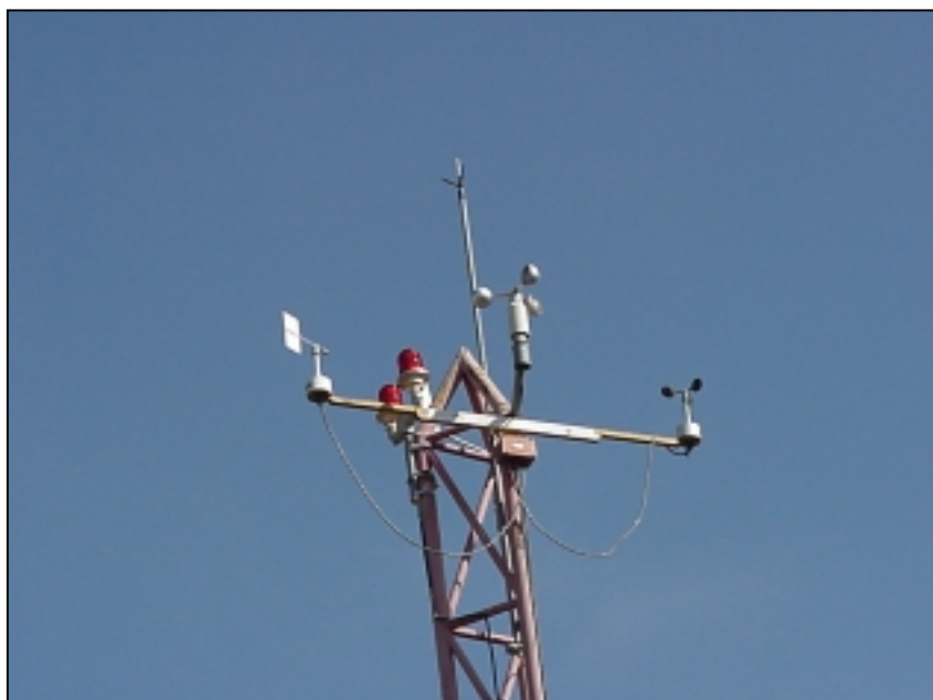
รูปที่ 2.10 เครื่องมือวัดความเร็วลมแบบอัตโนมัติ
