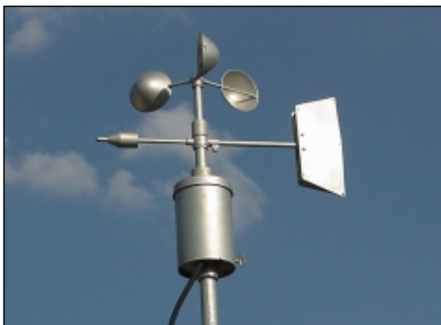
รูปที่ 2.6 เครื่องมือวัดความเร็วลมลูกถ้วย
