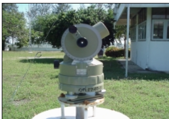
รูปที่ 2.2 กล้องวัดมุม (Theodolite)
