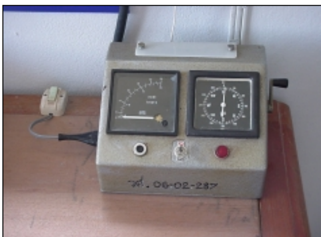
รูปที่ 2.7 หน้าปัดแสดงความเร็วลมและทิศทางลมเครื่องมือวัดความเร็วลมแบบลูกถ้วย
