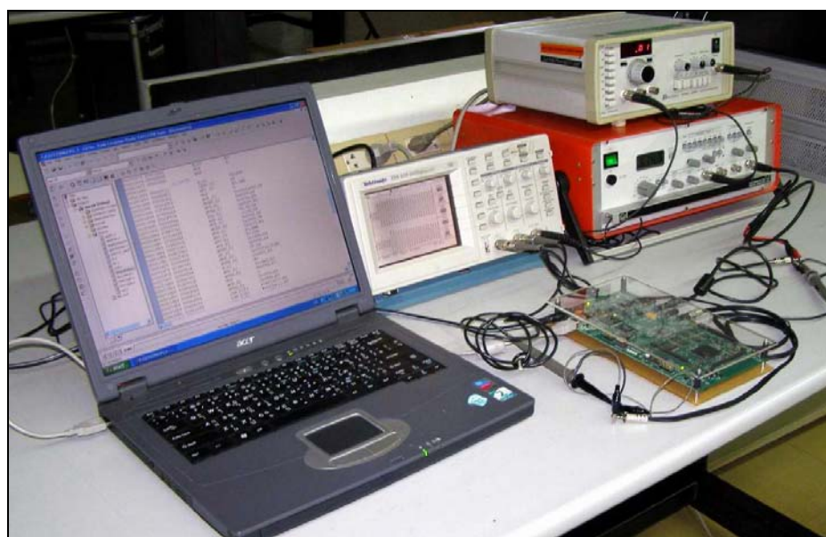
รูปที่ 4.8 ลักษณะการต่ออุปกรณ์เพื่อทดลองวัดช่วงเวลาย้ำกระทำและช่วงเวลาเลิกกระทำของแต่ละแบนด์
