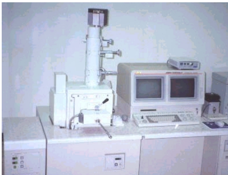
ภาพที่ 2.9 ภาพของกล้องจุลทรรศน์แบบ SEM รุ่น JSM – 5800 LV ของบริษัท JEOL
