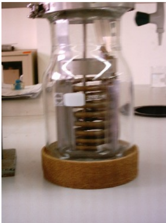
รูปที่ 3.28 ถังตกผลึกจำลองในห้องปฏิบัติการวิศวกรรมเคมี
