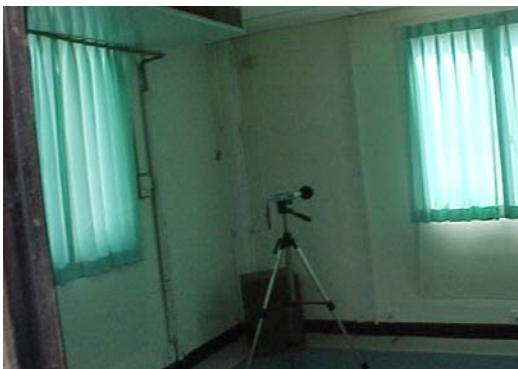
ภาพที่ 3.7 ห้องทดลองการดูดซับเสียงและสูญเสียพลังงานเสียงขณะส่งผ่าน
