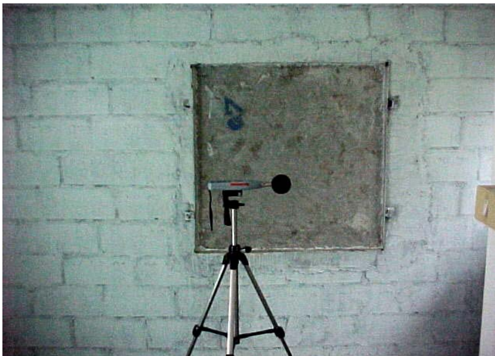
ภาพที่ 3.20 ลักษณะการติดตั้งเครื่องวัดเสียงในห้องกำเนิดเสียง หลังจากติดตั้งแผ่นวัสดุ
