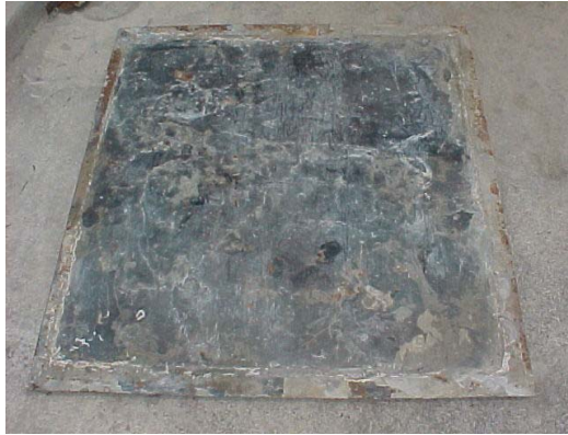
ภาพที่ 3.8 แบบหล่อแผ่นวัสดุชุบเสี้ยน : 1. กรอบความหนา 10 Cm. 2. กรอบความหนา 7.5 Cm. และ 3. กรอบความหนา 5 Cm.
