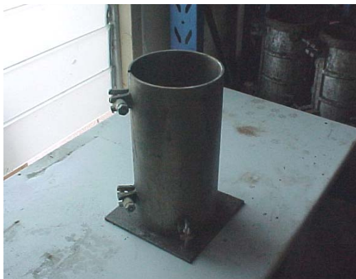
ภาพที่ 3.10 แบบหล่อแท่งคอนกรีตทดสอบ ค่ากำลังรับแรงอัด (Compressive Strength)
