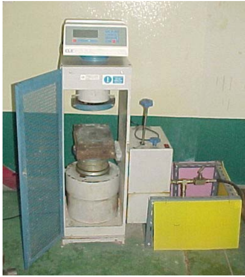
ภาพที่ 3.12 เครื่องทดสอบค่าความสามารถ ในการรับแรงอัด
