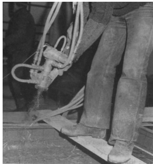
ภาพที่ 2.9 การบรรจุ เส้นใยแก้ว ลงในซีเมนต์ โดยใช้ Putzmeister Concentric Spraygun (Graham True, 1986)
