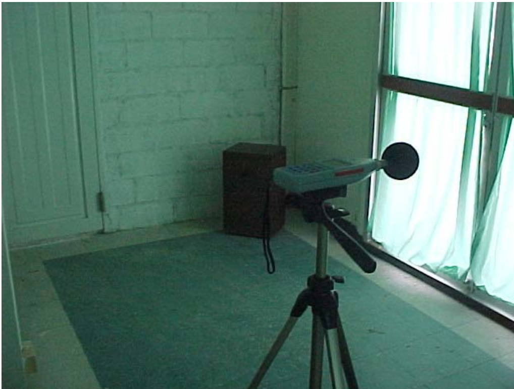
ภาพที่ 3.23 ลักษณะการติดตั้งแหล่งกำเนิด (Loud speaker) เสียงในห้องกำเนิดเสียง (Source Room) ภายในห้องทดลองการสูญเสียพลังงานเสียงขณะส่งผ่าน
