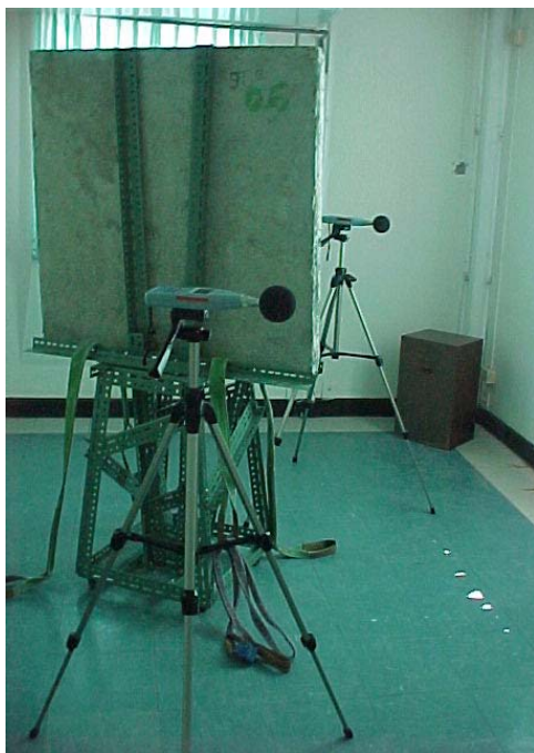
ภาพที่ 3.17 ลักษณะการติดตั้งแผ่นวัสดุภายในห้องทดลองการดูดซับเสียง
