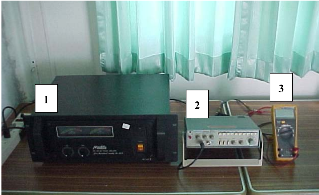
ภาพที่ 3.4 อุปกรณ์กำเนิดคลื่นเสียง ประกอบด้วย 1.เครื่องขยายสัญญาณ 2.เครื่องกำเนิดคลื่นความถี่และ 3. เครื่องวัดค่าความถี่
