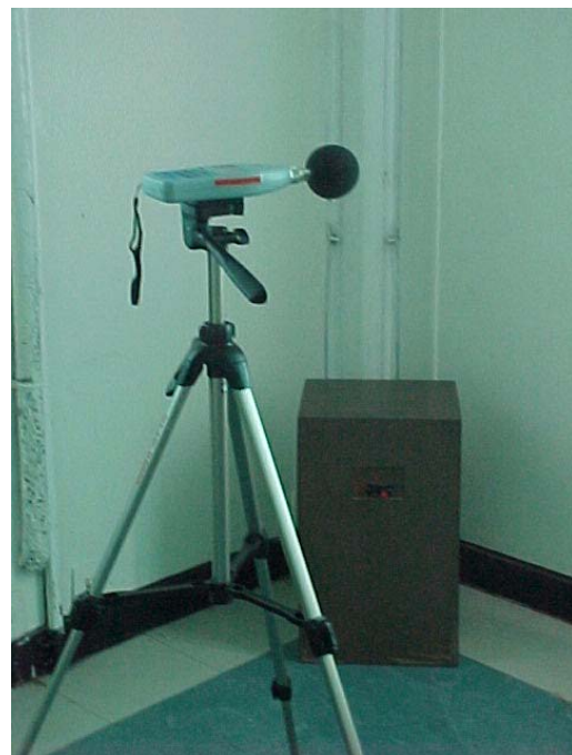
ภาพที่ 3.18 ลักษณะการติดตั้งแหล่งกำเนิดเสียงในห้องทดลอง
