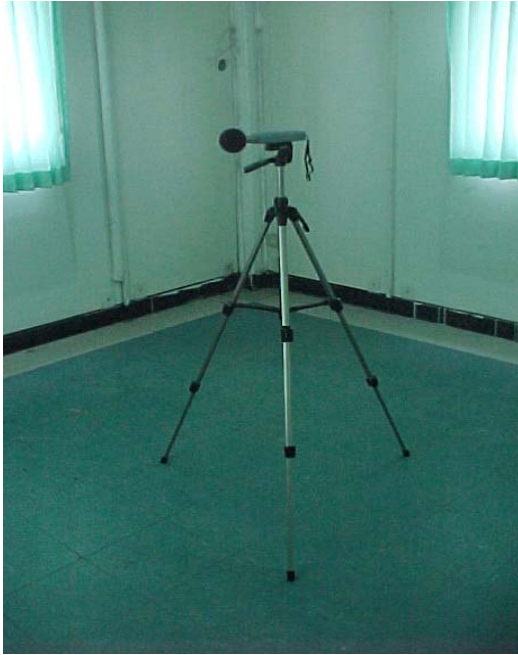
ภาพที่ 3.21 ลักษณะการติดตั้งเครื่องวัดเสียง ในห้องรับเสียง (Receiver Room)
