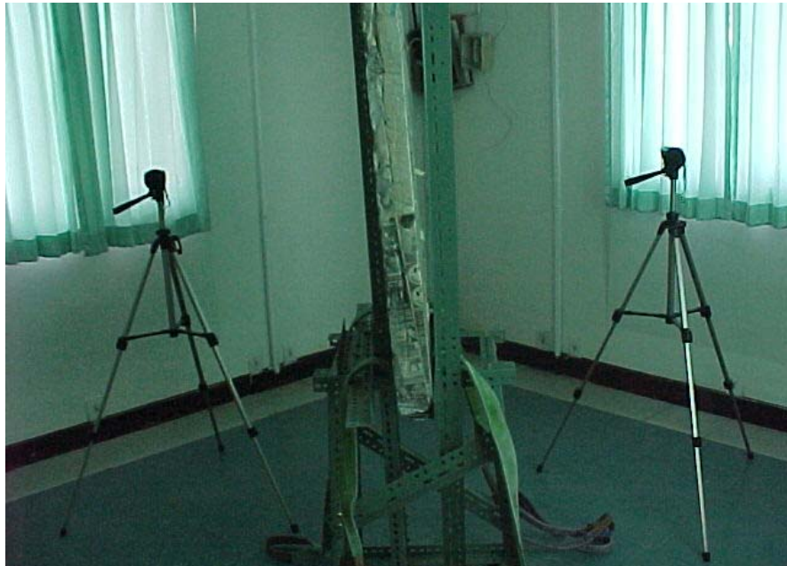
ภาพที่ 3.16 ลักษณะการติดตั้งเครื่องวัดเสียงภายในห้องทดลองการดูดซับเสียง
