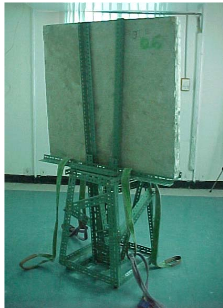
ภาพที่ 3.15 ลักษณะการติดตั้งแผ่นวัสดุ
