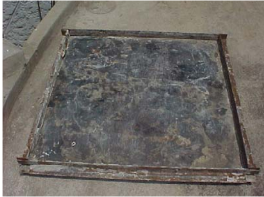
ภาพที่ 3.9 แบบหล่อแผ่นวัสดุชุบเสี้ยน ความหนา 5 Cm.
