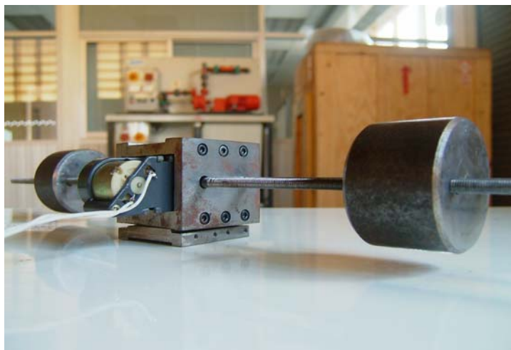
รูปที่ 5.3 อุปกรณ์ชั่งการสั่นที่ใช้ในการทดลอง
