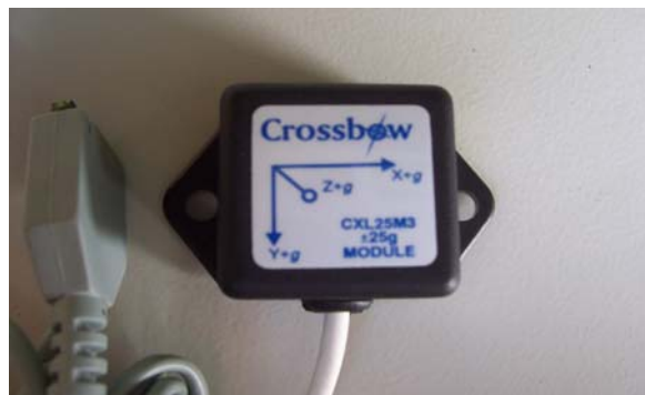
รูปที่ ฅ.3 ภาพถ่ายของอุปกรณ์ตัวตรวจวัดความเร่ง รุ่น CXL 25M3
