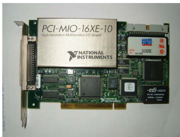
รูปที่ 5.4 DAQ Card รุ่น PCI-MIO-16XE-10
