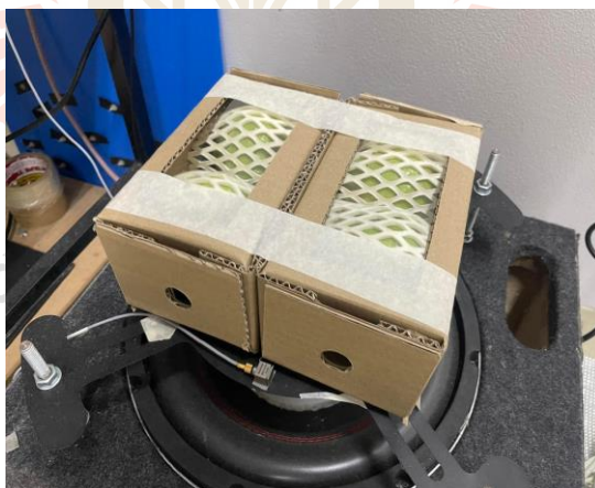
รูปที่ 3.1 แสดงลักษณะการทดสอบจำลองการสั่นสะเทือนกับฝรั่ง
