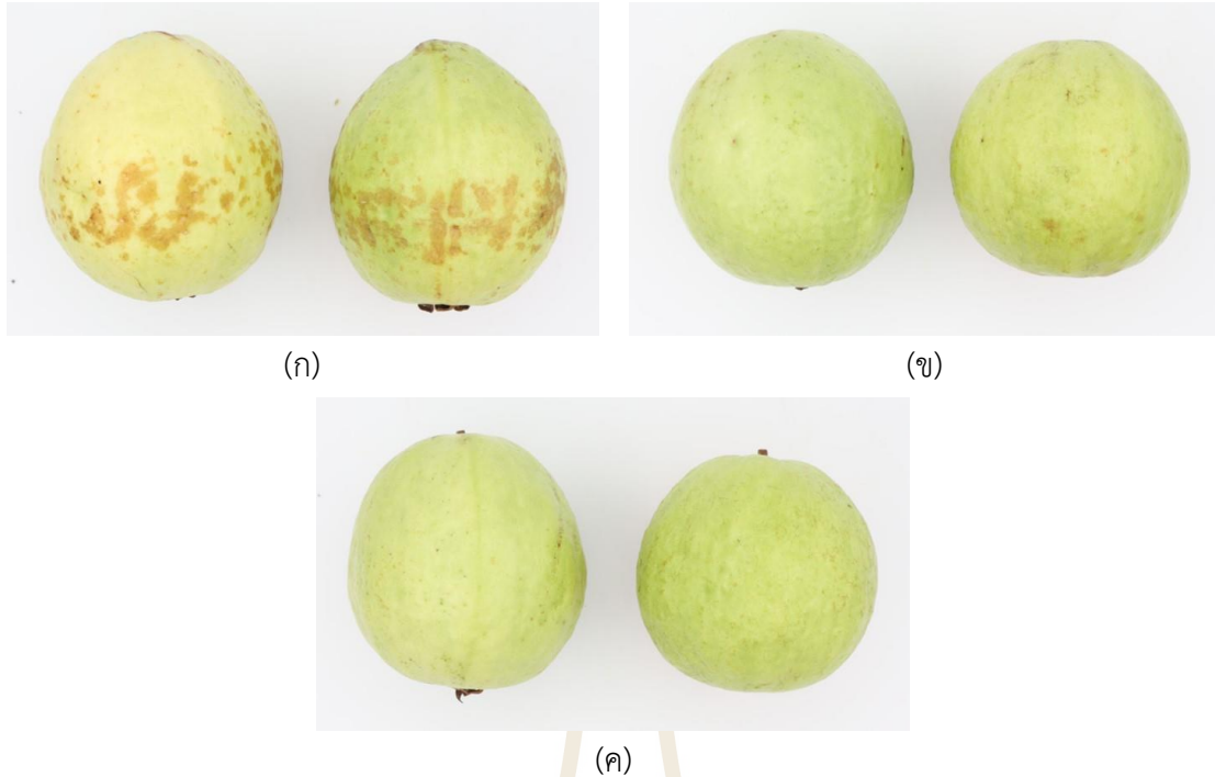
รูปที่ 2.3 ลักษณะผลิตผลสดหลังการทดสอบประสิทธิภาพของวัสดุกันกระแทกในสภาวะจำลองด้วยการสั่น (vibration test) เทียบกับผลไม้ที่ไม่ได้ห่อด้วยวัสดุกันกระแทก (ก) ผลไม้ที่ไม่ได้ห่อด้วยโฟมตาข่ายกันกระแทก (Control) (ข) โฟมตาข่ายกันกระแทกทางการค้า (ค) โฟมตาข่ายกันกระแทกจากน้ำยางธรรมชาติที่พัฒนาขึ้น
