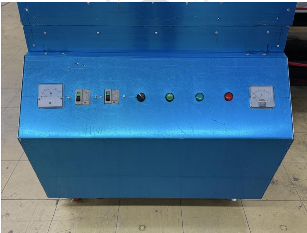
รูปที่ 3.7 ระบบควบคุมการทำงานของเครื่องสร้างสนามไฟฟ้าด้วยคลื่นความถี่วิทยุ
