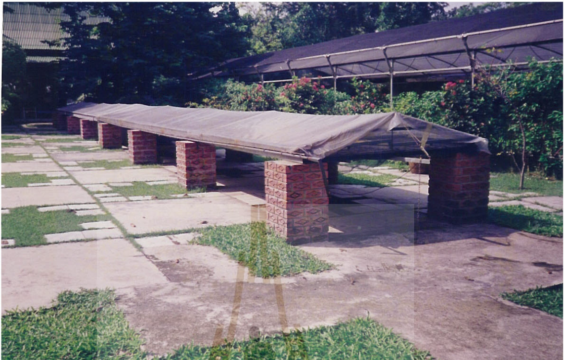
รูปที่ 3.1 เครื่องอบแห้งพลังงานแสงอาทิตย์ชนิดอุโมงค์ลม
