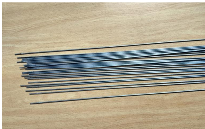
รูปที่ 3.4 ลวดเชื่อมเติมเนื้อ เกรด P20 ตามมาตรฐาน AISI
