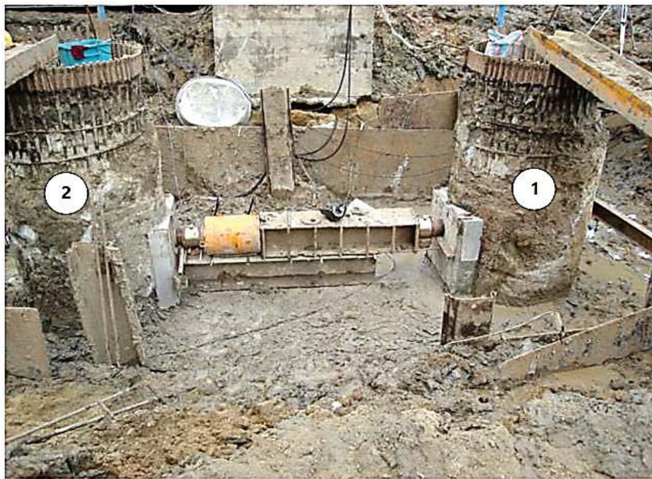
รูปที่ 2.31 การทดสอบเสาเข็มเจาะในสนาม (Submaneewong, 2009)
