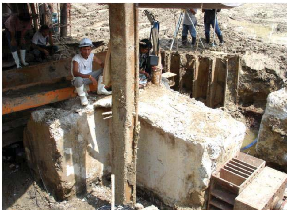
รูปที่ 2.33 การทดสอบเสาเข็มแบบเรีตูปตัวที่ในสนาม (Submaneeewong, 2009)
