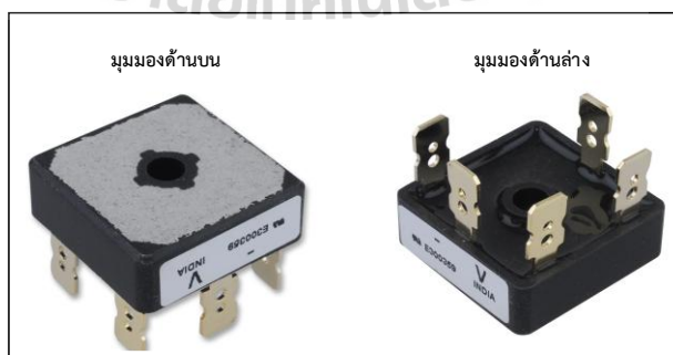
รูปที่ 6.2 วงจรเรียงกระแสสามเฟสแบบบริดจ์
