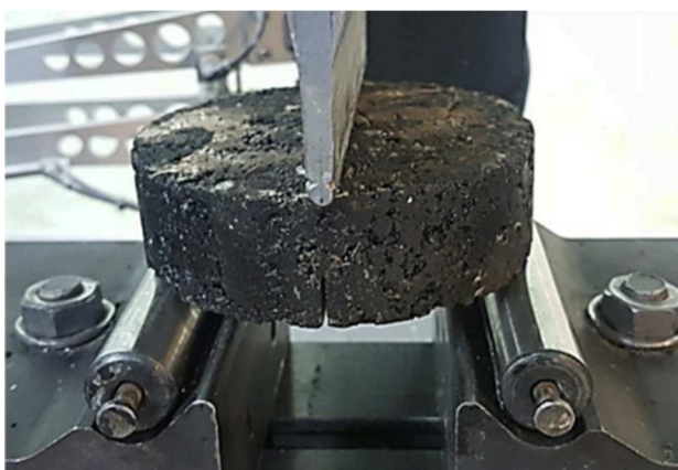
รูปที่ 2.9 แสดงการทดสอบความต้านทานการแตกหักวิจัยของคุณ PJ Haghighatpour et al. [34]
