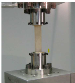
รูปที่ 2.8 แสดงการทดสอบความต้านทานการแตกหักจากงานวิจัยของคุณ F Ren et al. [33]
