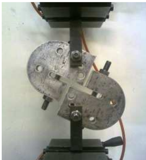
รูปที่ 2.10 แสดงการทดสอบความต้านทานการแตกหักงานวิจัยของคุณ M.R.Ayatollahi et al. [36]
