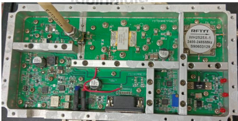
รูปที่ 3.7 ชุดขยายสัญญาณใช้ทรานซิสเตอร์ เบอร์ BLF7G24LS-140 สำหรับออกแบบ Power Amplifier
